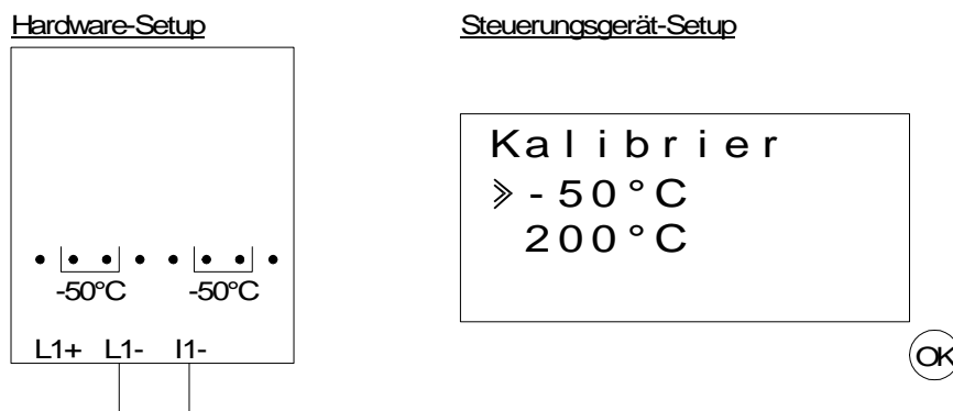
Abbildung 12.5: Abgleich des Offset beim AL2-2PT-ADP
