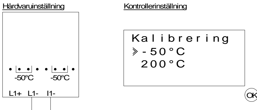
Figur 12.5: Avstämning av offset för AL2-2PT-ADP
