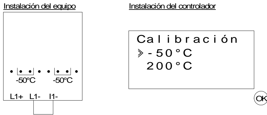
Figura 12.5: Compensación de la desviación en el AL2-2PT-ADP
