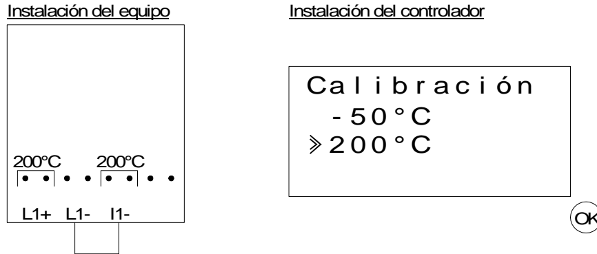
Figura 12.7: Compensación de la amplificación en el AL2-2PT-ADP
