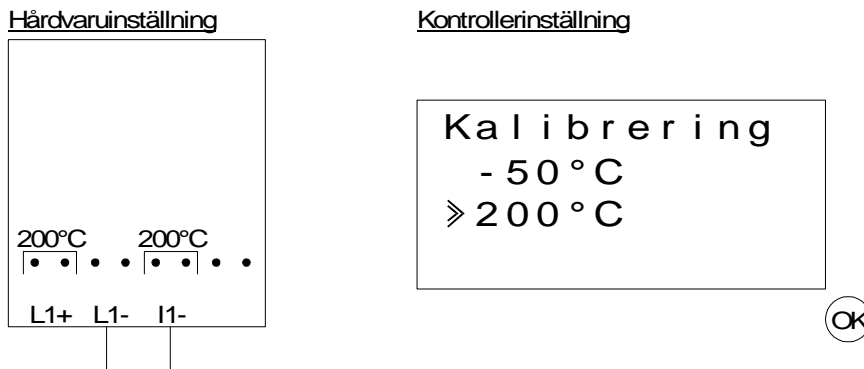
Figur 12.7: Avstämning av förstärkningen för AL2-2PT-ADP
