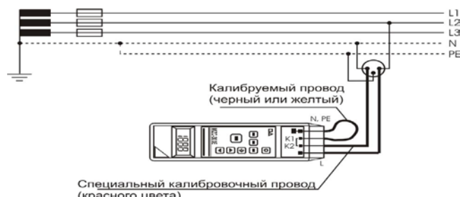
Рис. 11. Автокалибровка измерительных проводов.
