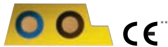
Abb. 3 ASi Kabelquerschnitt rechts = lange Bezugskante Fig. 3 Cable cross selection right = long reference edge
