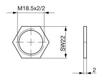
0098.0044 Max. torque 1.2 Nm 0098.0042 Max. torque 2.4 Nm
