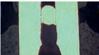
Schliffbild Flachbandkabel AWG-26 Massivdraht 90° Kabelabgang
