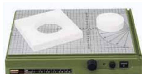
Приклеенная скотчем кнопка прекрасно выполняет роль центра вращения детали.
