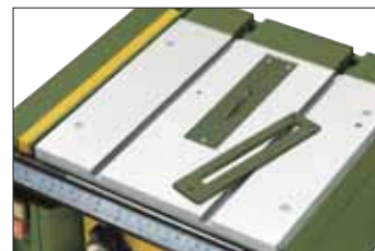
Планка из ABS для более высокой точности при резке мелких деталей (прорезается снизу диском FET).
