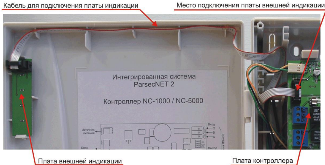
Рисунок 27. Подключение платы внешней индикации
