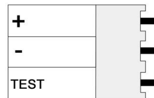
Рисунок 4. Назначение контактов разъема POWER
