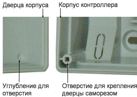
Рисунок 6. Схема «жесткого» крепления дверцы к корпусу контроллера
