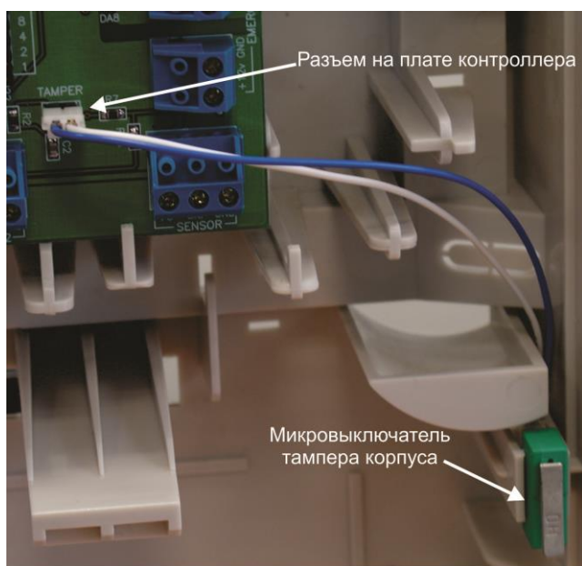
Рисунок 23. Подключение тампера корпуса
