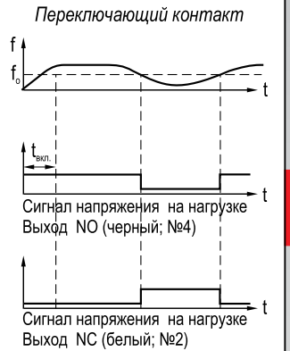
Диаграмма работы датчиков постоянного напряжения
