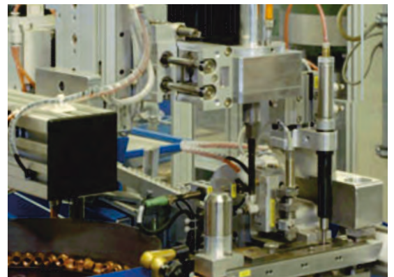
Автоматическая установка вставок HELICOIL® plus M8 screwlock с подачей из вибробункера.
