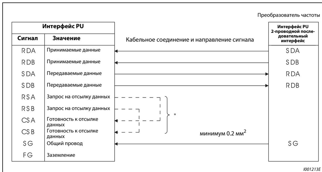
**Рис. 6-146:** Кабельное соединение с преобразователем частоты
