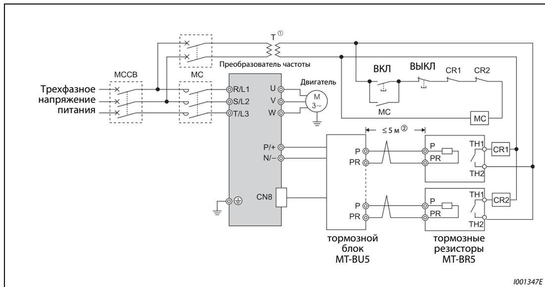
**Рис. 3-27:** Подключение с блоком торможения MT-BU5
