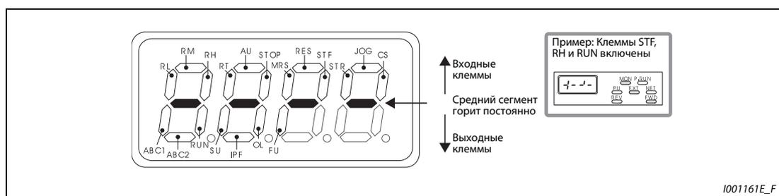
**Рис. 6-78:** *Индикация коммутационных состояний клемм ввода/вывода*
