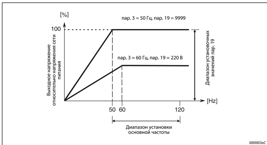
Рис. 6-13: Отношение выходного напряжения к выходной частоте
