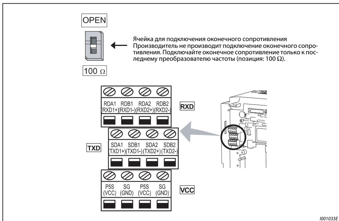
Рис. 6-147: 2.-проводной последовательный интерфейс преобразователя частоты
