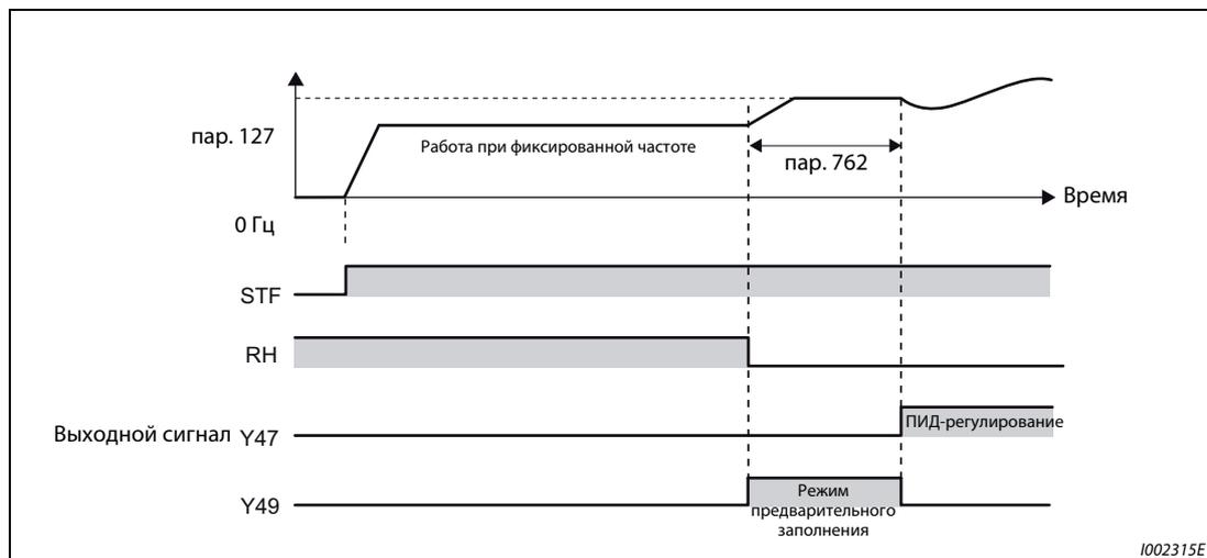
**Рис. 6-193:** Переключение с другого вида управления на ПИД-регулирование
