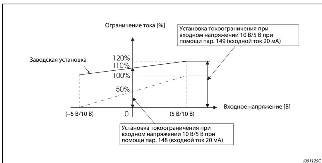
**Рис. 6-9:** Аналоговая настройка токоограничения через клемму 1**УКАЗАНИЯ**
