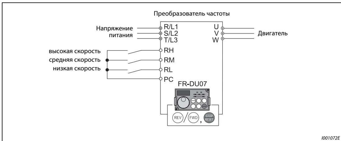
**Рис. 4-14:** Установка скорости вращения при помощи переключателя
