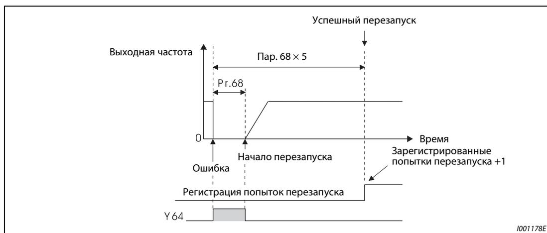
Рис. 6-102: Пример успешно выполненного перезапуска
