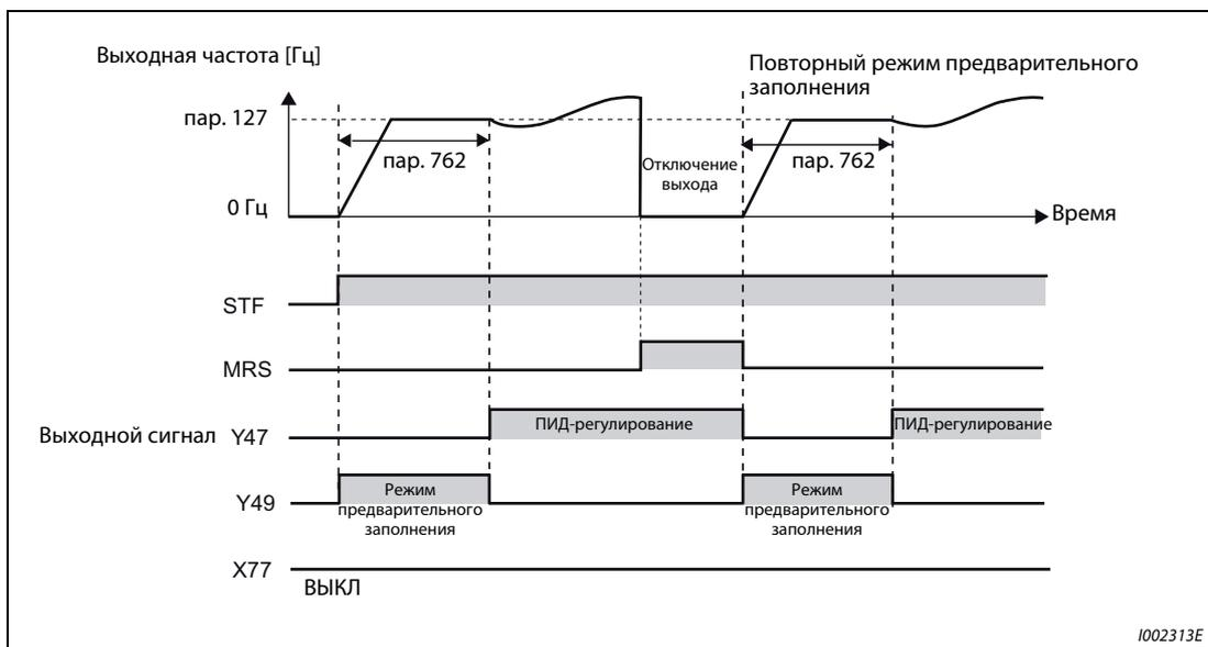
**Рис. 6-191:** Возобновление режима предварительного заполнения после отключения выхода
