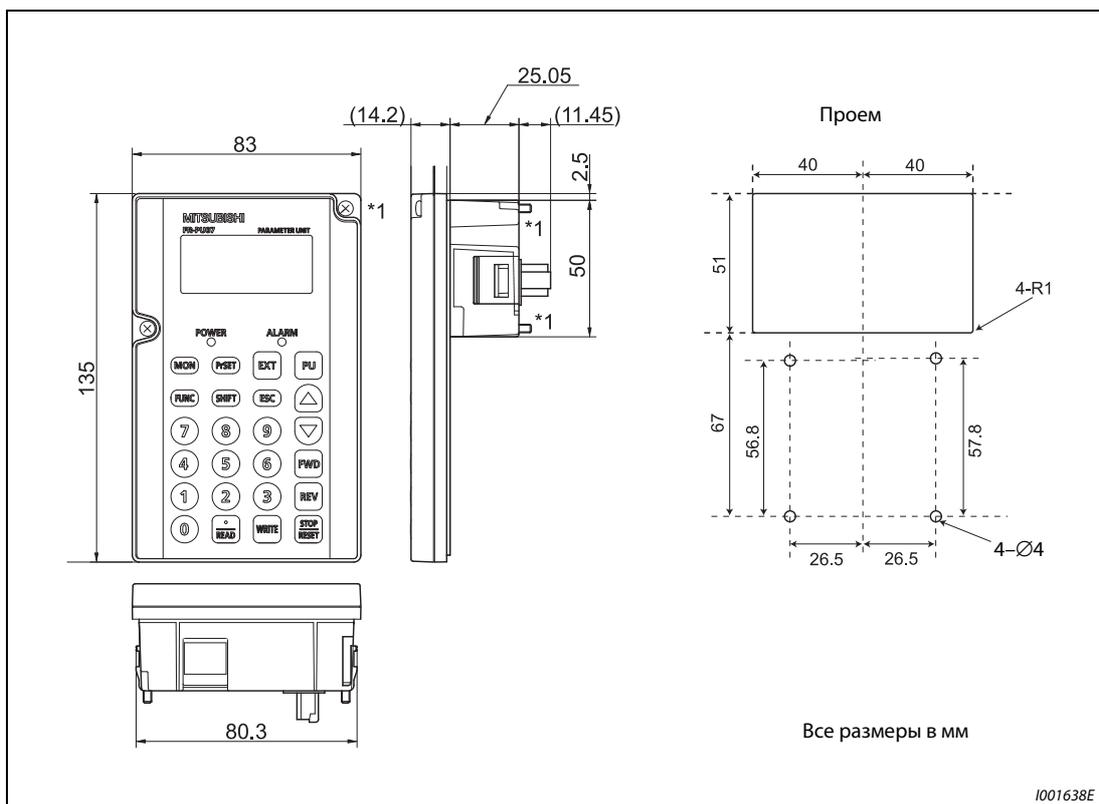
Рис. А-20: Панель управления FR-PU07
