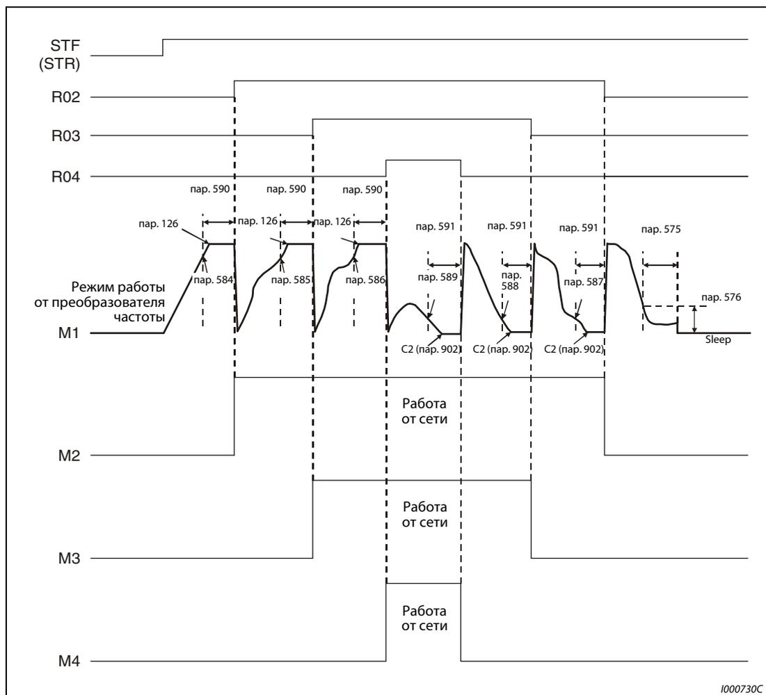
**Рис. 6-204:** *Переходная характеристика в стандартном режиме работы*
