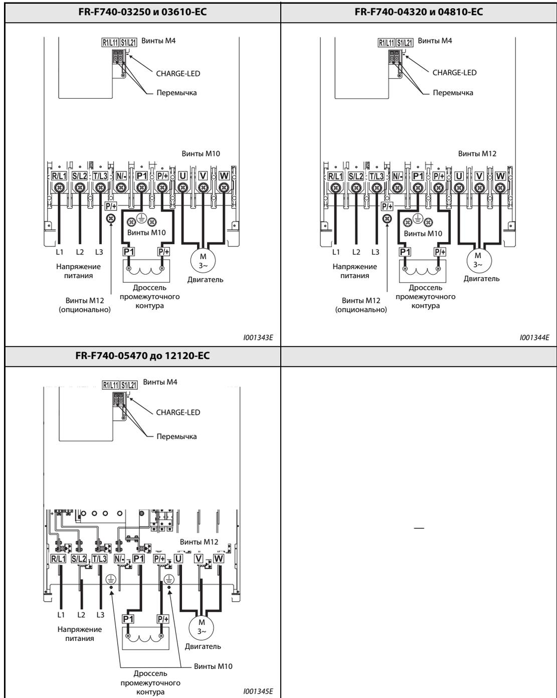
Таб. 3-3: Расположение клемм и проводные соединения (2)
