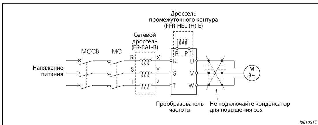
**Рис. 3-43:** Подавление высокочастотных гармоник в напряжении сети
