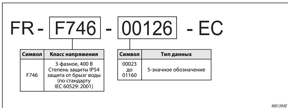
Рис. 1-2: Обозначение моделей преобразователей FR-F746 EC
