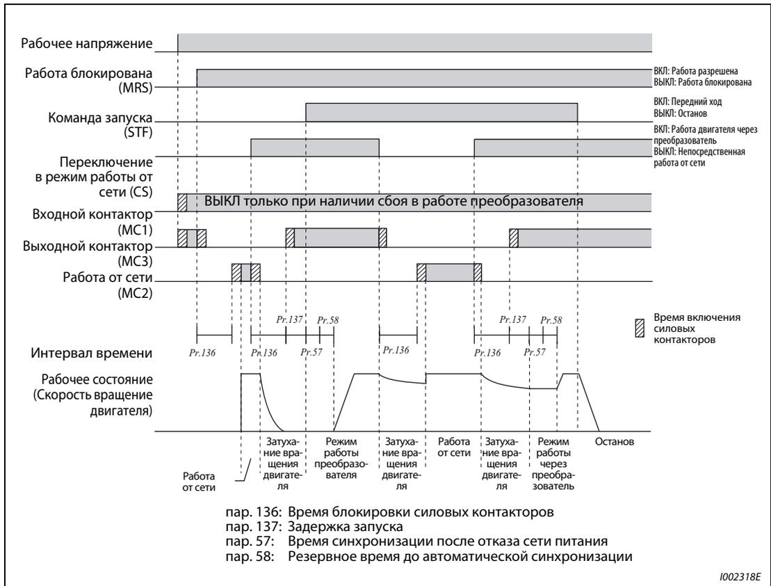
**Рис. 6-209:** Временная диаграмма сигналов без автоматического переключения в режим работы от сети
