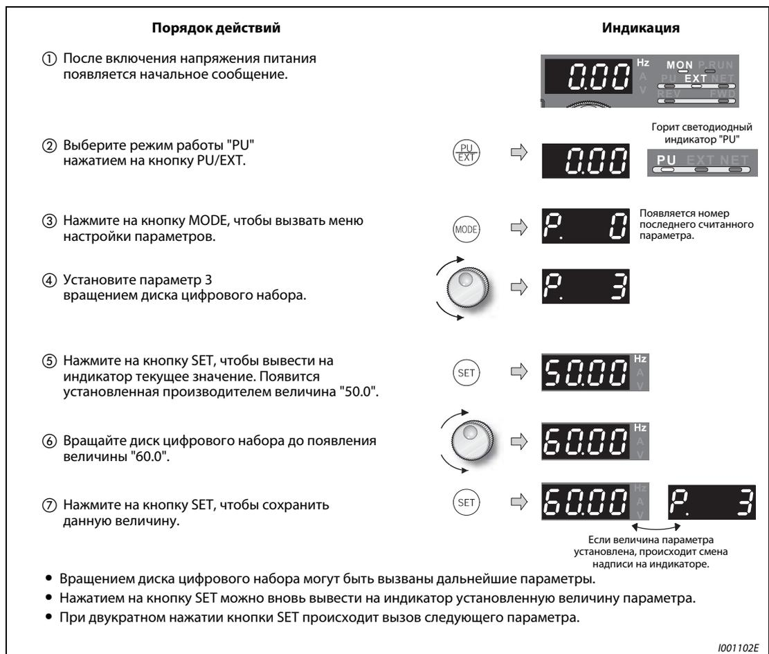
Рис. 5-5: Установка основной частоты
