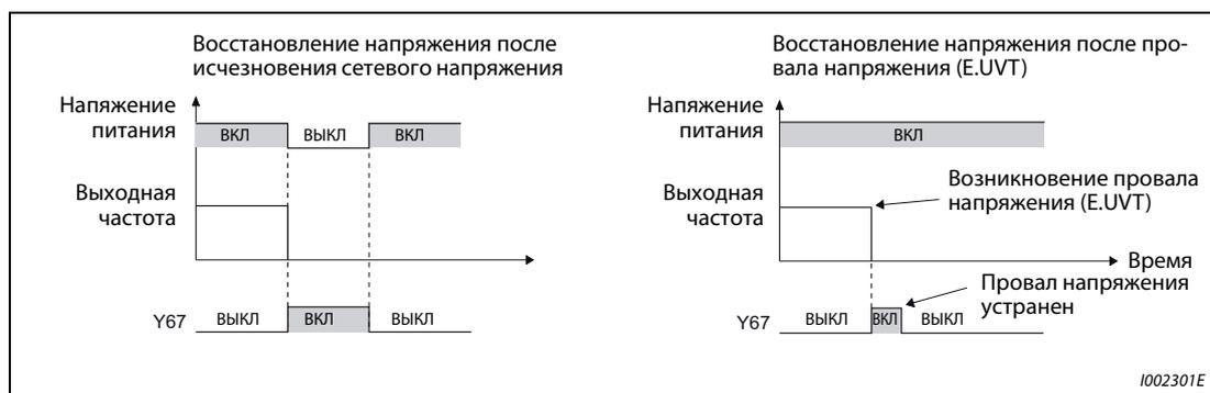
**Рис. 6-92:** Режим переключения сигнала Y67 после провала или исчезновения сетевого напряжения
