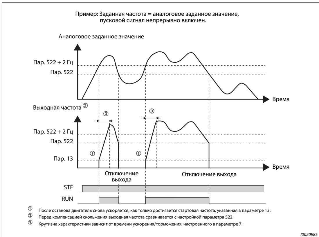
**Рис. 6-56:** Пример 2: Заданная частота = аналоговое заданное значение, пусковой сигнал непрерывно включен
