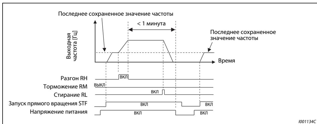
Рис. 6-28: Выдача частоты с последним сохраненным значением
