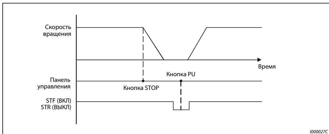
**Рис. 6-132:** Останов при работе в режиме внешнего управления
