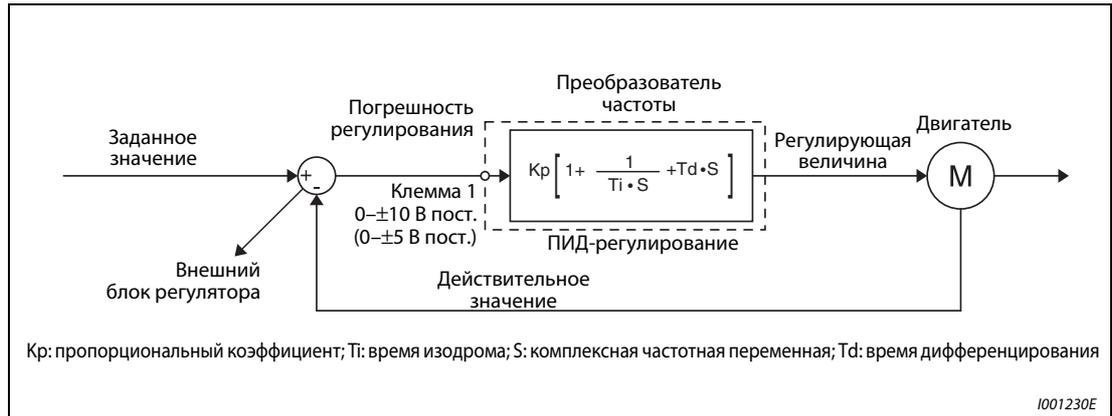
**Рис. 6-173:** Конфигурация системы для пар. 128 (пар. 573) = 10, 11, 110, 111 (Применение внешнего блока (ПИД)-регулятора)
