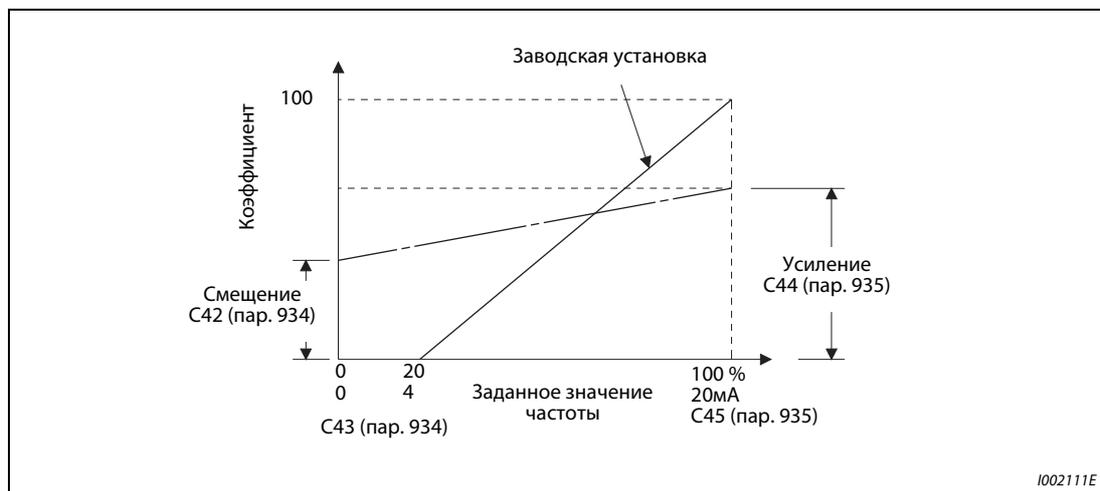
**Рис. 6-186:** Смещение и усиление для ПИД-индикации
