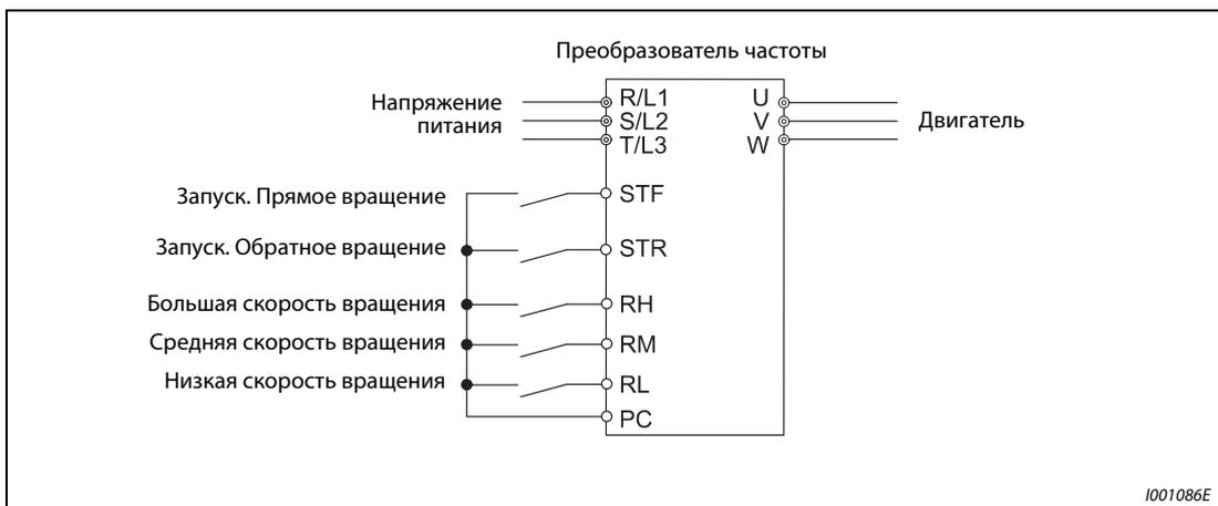
**Рис. 4-23:** Предустановка скорости вращения и ввод команды запуска при помощи переключателя.
