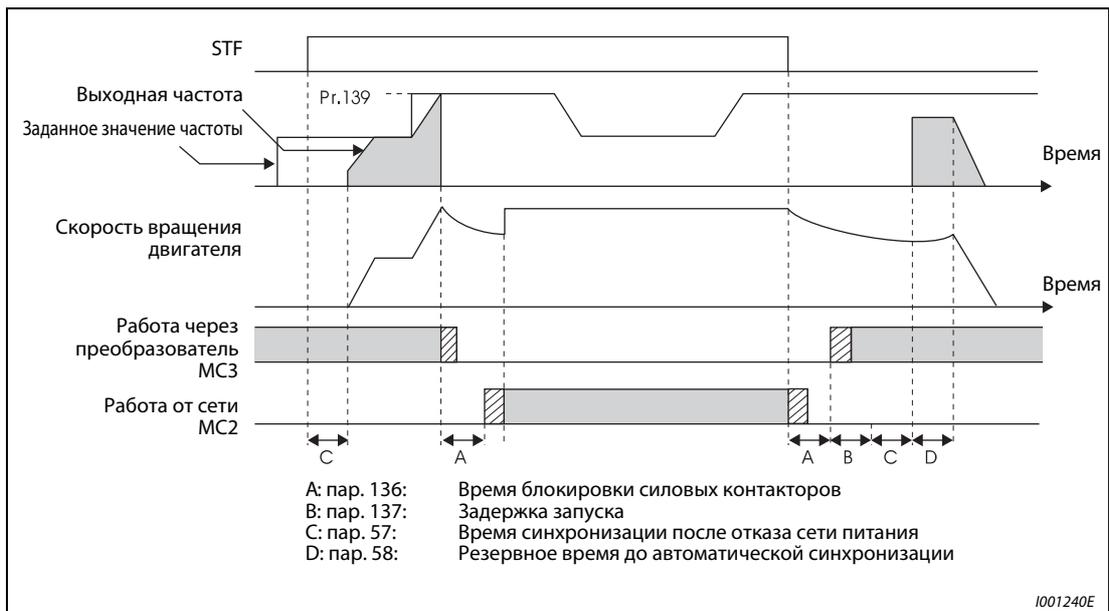
**Рис. 6-210:** Временная диаграмма сигналов с автоматическим переключением в режим работы от сети
