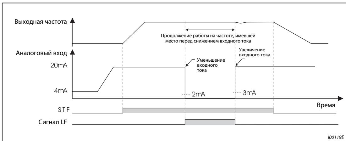
**Рис. 6-126:** Снижение заданной величины тока при работе в режиме внешнего управления (пар. 573 = 1)
