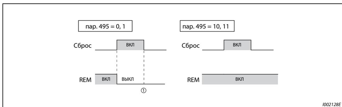
**Рис. 6-74:** Данные децентрализованного вывода при сбросе преобразователя частоты
