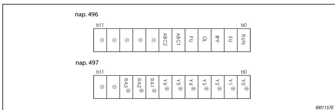
**Рис. 6-72:** Децентрализованные выходные данные
