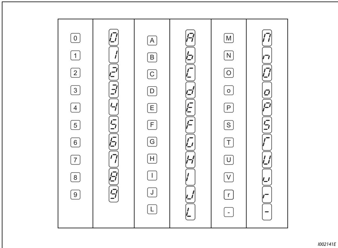
**Рис. 7-4:** Коды светодиодной индикации панели управления FR-DU07
