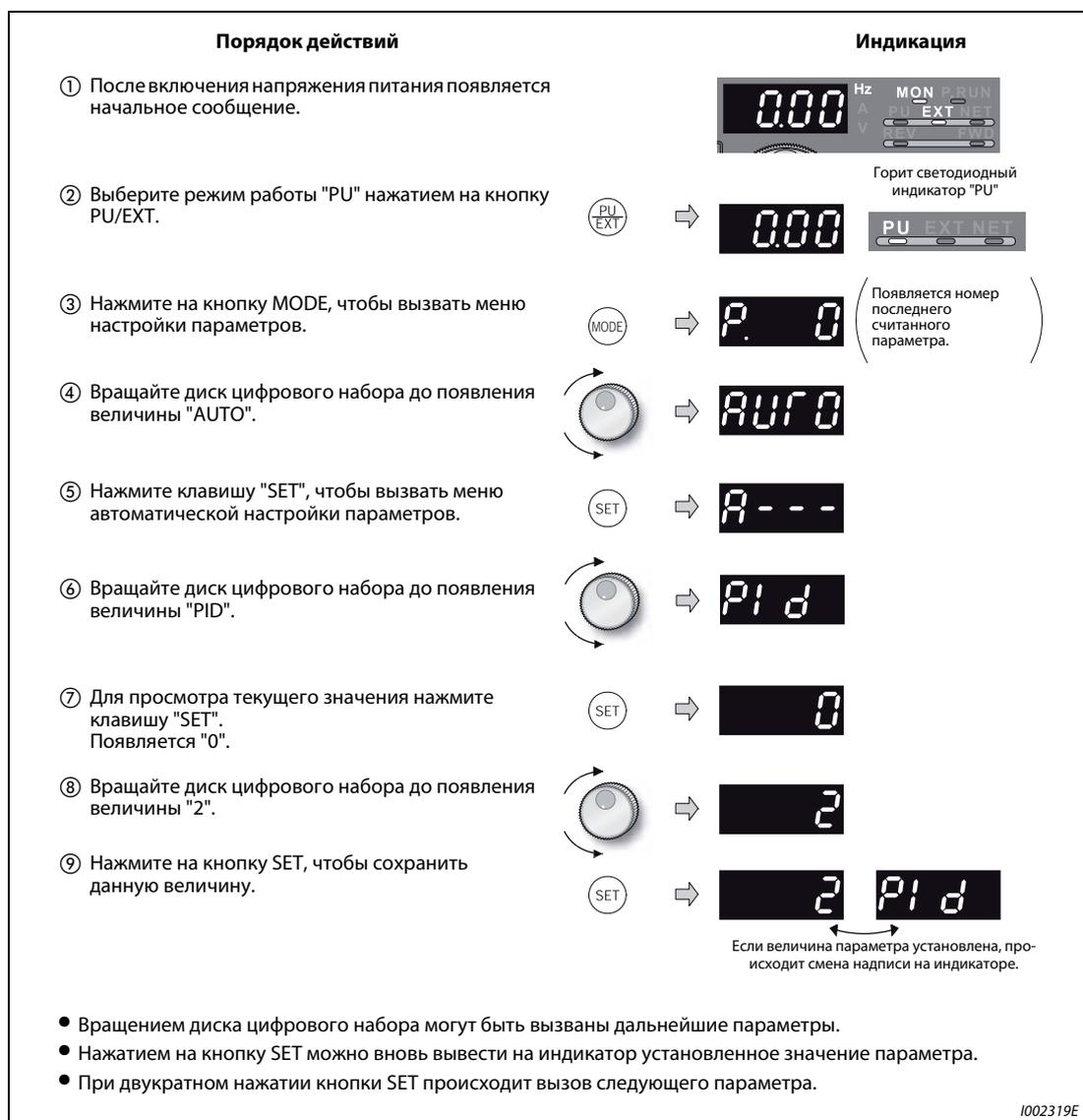
**Рис. 6-223:** Автоматическая настройка параметров
