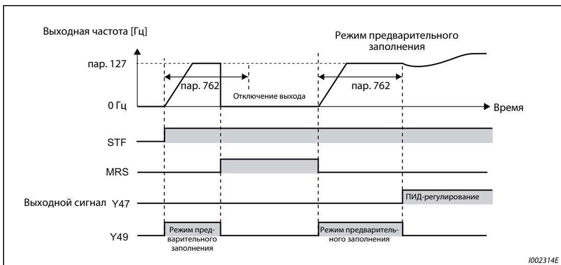
**Рис. 6-192:** Отключение выхода во время режима предварительного заполнения
