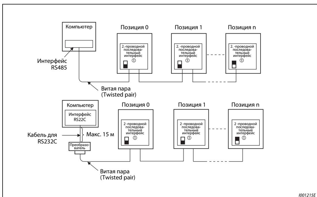
**Рис. 6-150:** Кабельное соединение с несколькими преобразователями частоты
