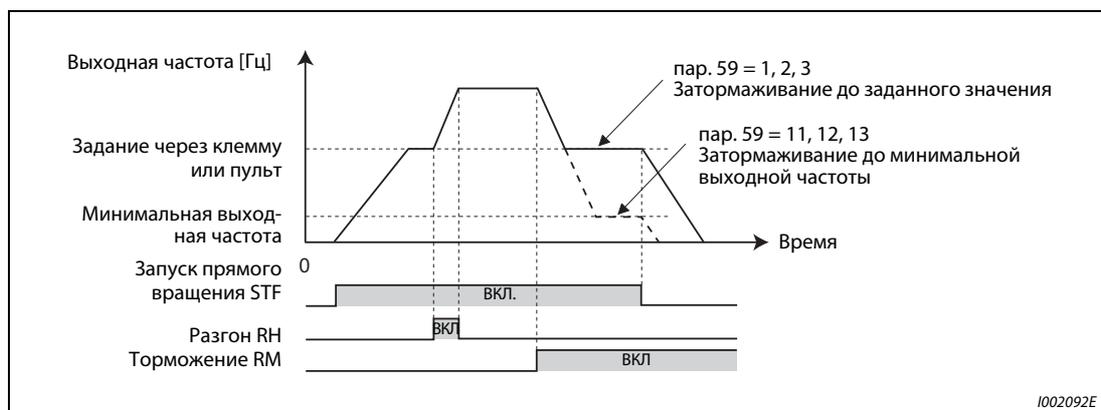
Рис. 6-27: Пример работы цифрового потенциометра двигателя (2)
