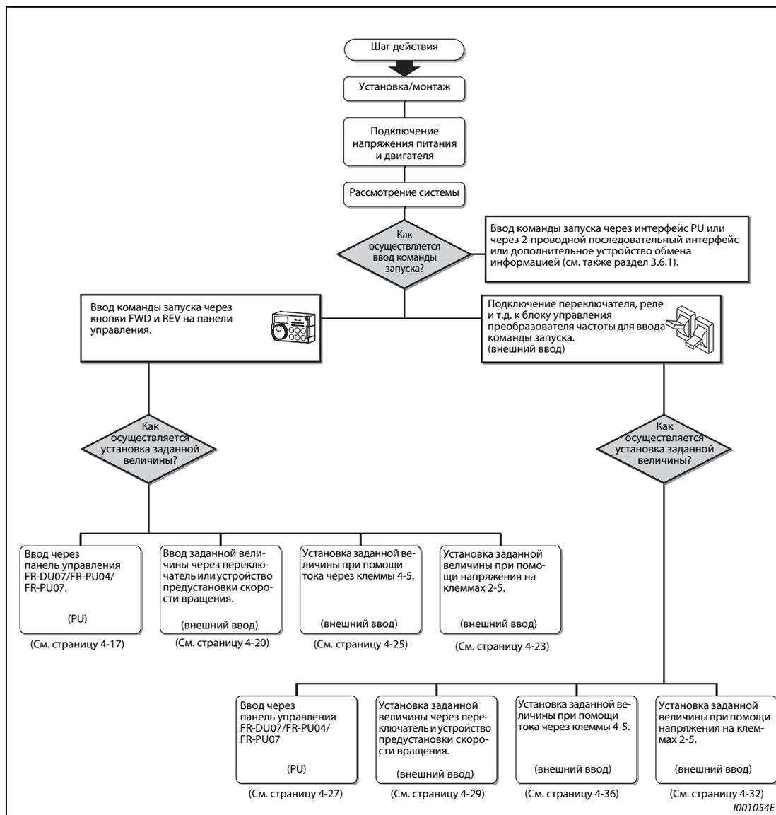
**Рис. 4-2:** Последовательность действий при вводе в эксплуатацию.
