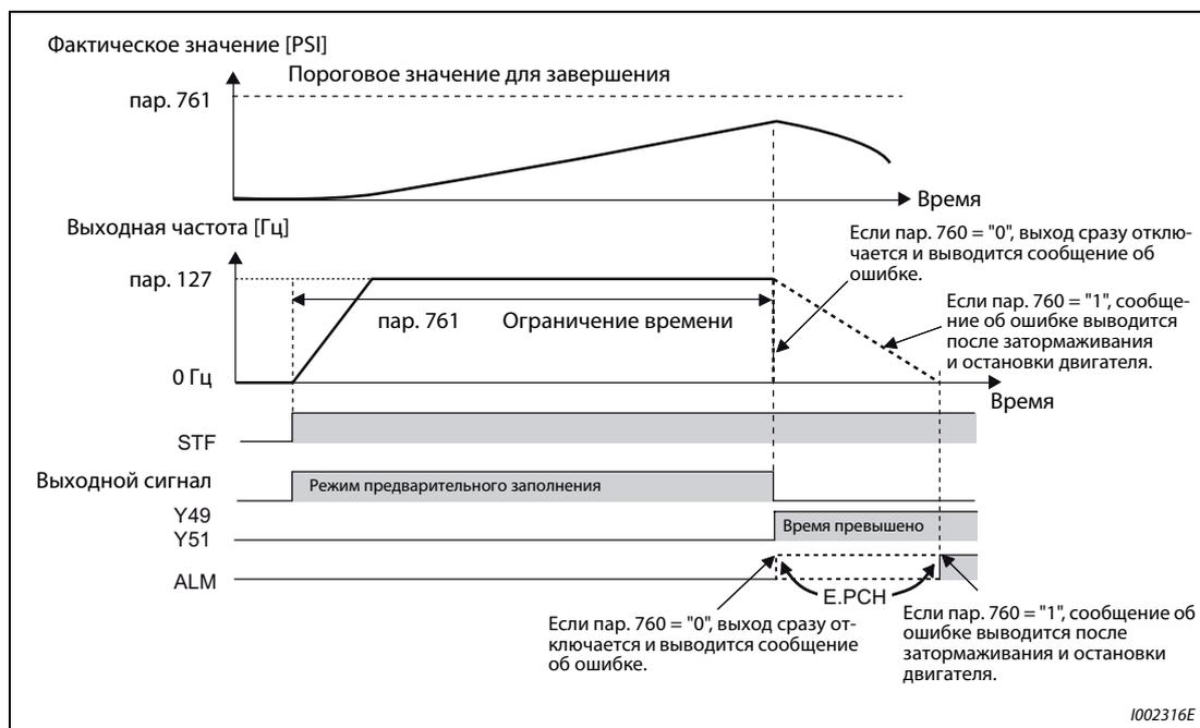
**Рис. 6-194:** Достижение предела времени при режиме предварительного заполнения
