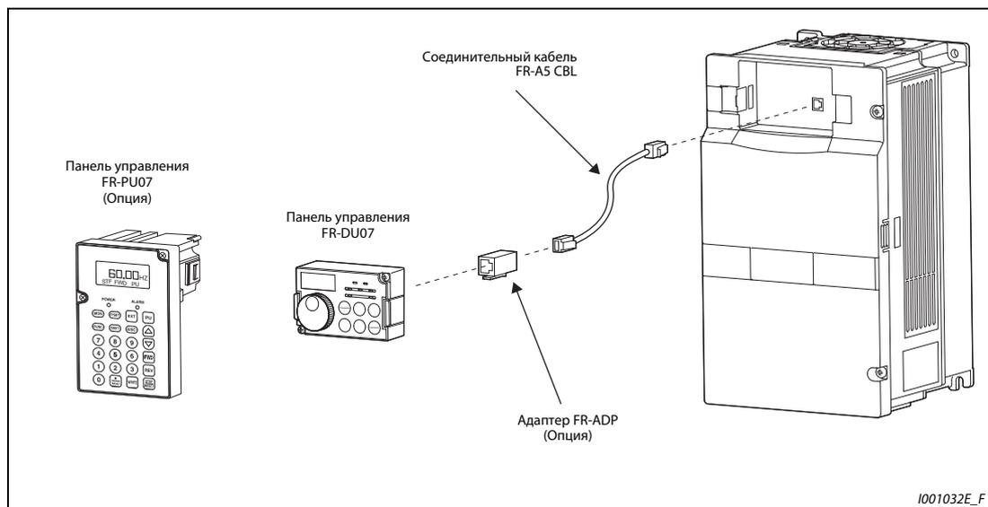
**Рис. 3-22:** Децентрализованное подключение панели управления
