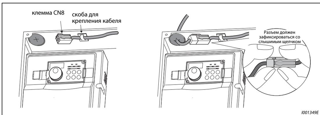
**Рис. 3-29:** Подключение клеммы CN8
