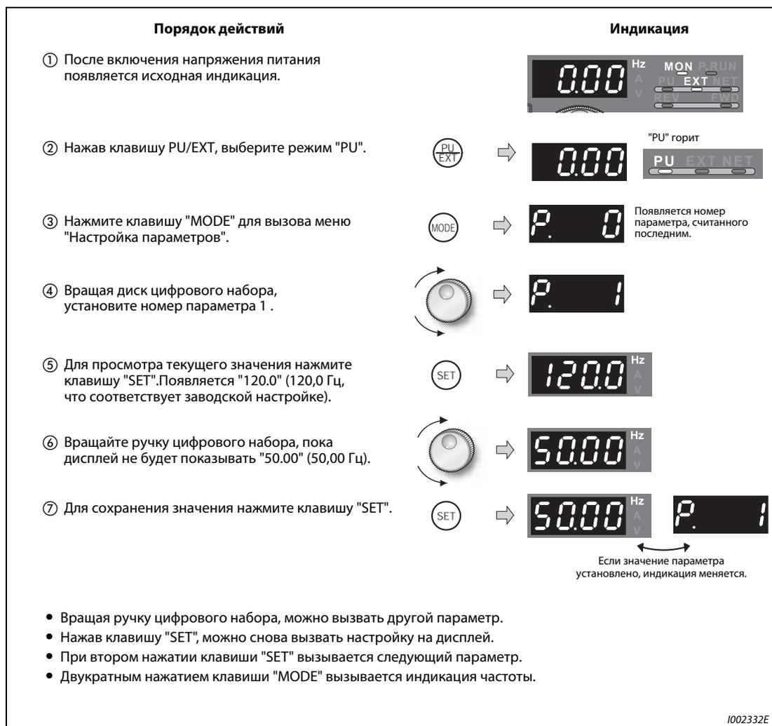
**Рис. 4-9:** Установка максимальной выходной частоты
