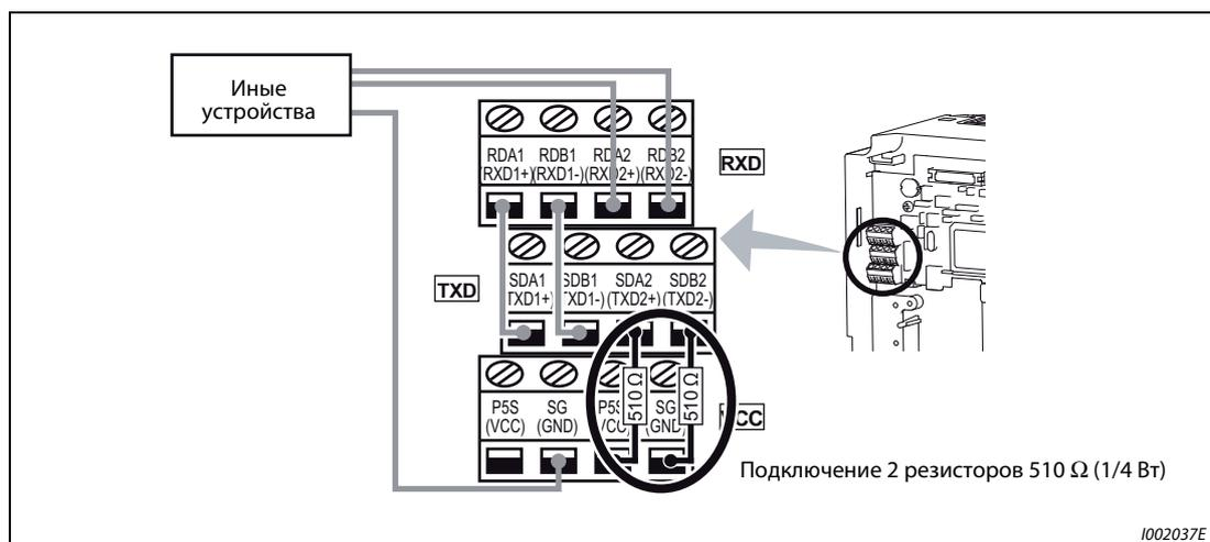
**Рис. 6-171:** Подключение нагрузочных резисторов к преобразователю частоты
