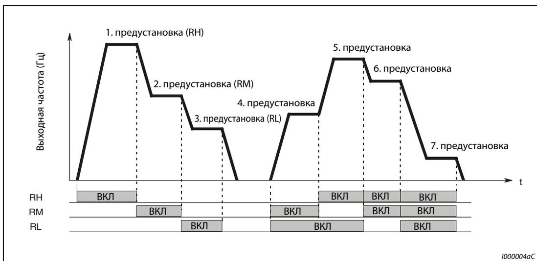
**Рис. 4-15:** Вызов предустановок скорости в зависимости от наличия сигналов на клеммах
