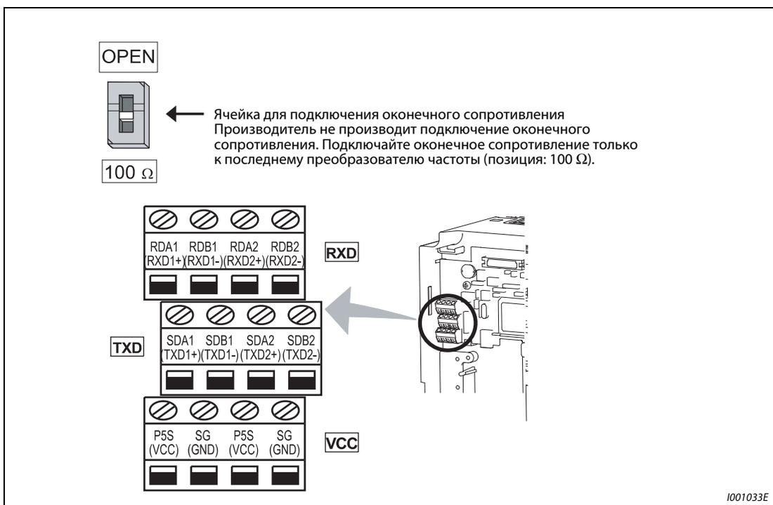
**Рис. 3-23:** 2-проводной последовательный интерфейс преобразователя частоты
