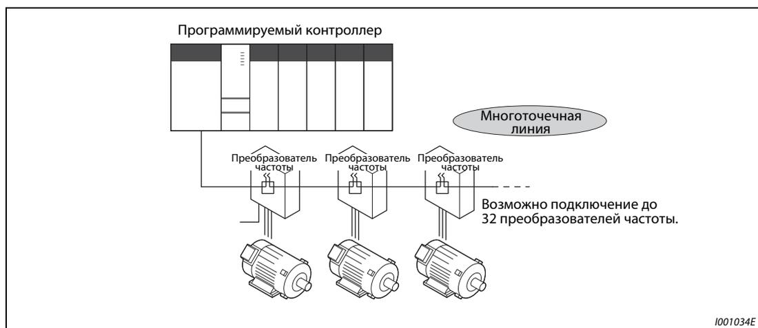
**Рис. 3-24:** 2-проводной последовательный интерфейс преобразователя частоты
