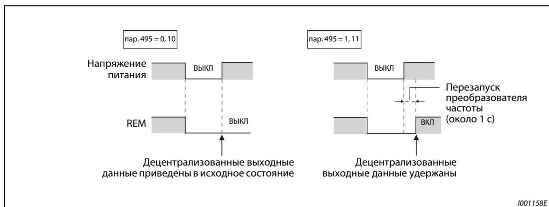
**Рис. 6-73:** Децентрализованные выходные данные при выключении питания.
