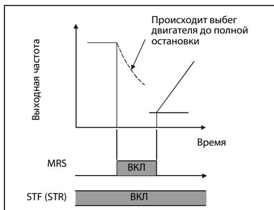
Рис. 6-57: Блокировка регулятора
