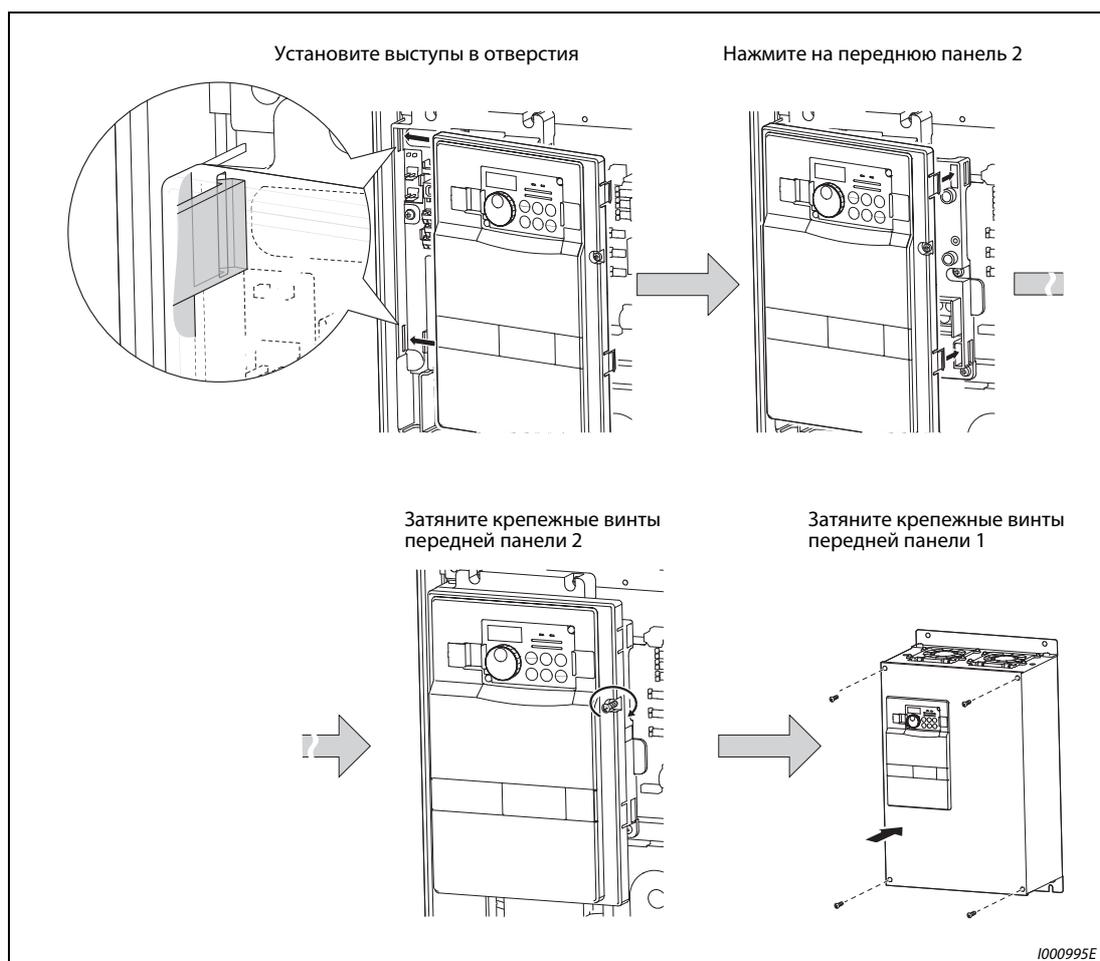
**Рис. 2-5:** Установка передней панели**УКАЗАНИЯ**
