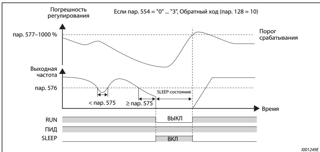
Рис. 6-202: Отключение выхода при обратном ходе (пар. 554 = "10" ... "13", пар. 128 = "10 "
