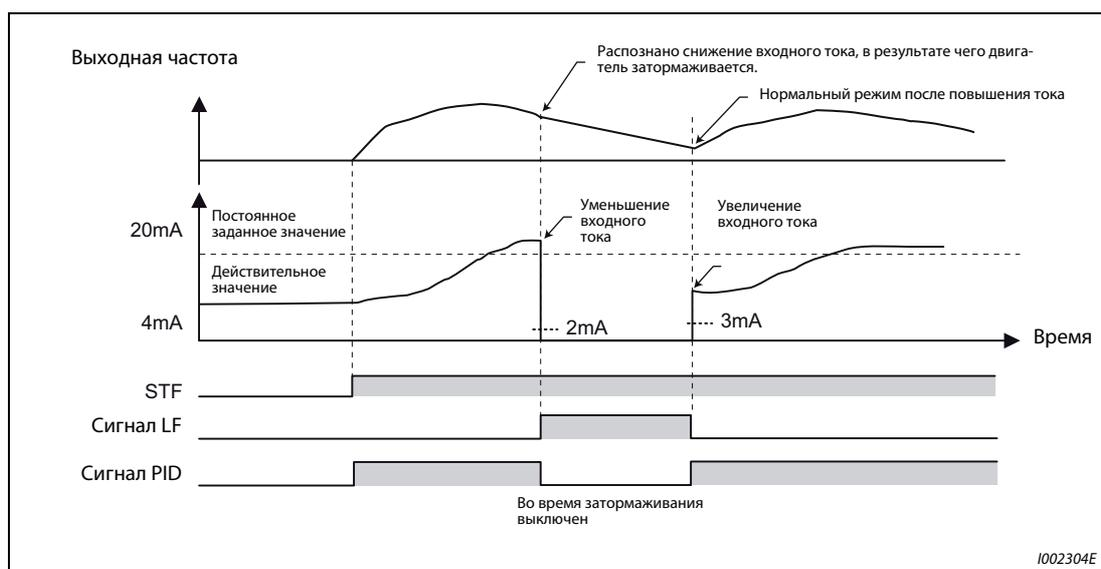
**Рис. 6-129:** Потеря токового заданного значения при ПИД-регулировании (Задний ход, пар. 573 = 3) (Во время затормаживания аналоговый входной ток снова повышается)
