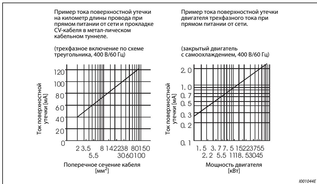
**Рис. 3-37:** Токи поверхностной утечки
