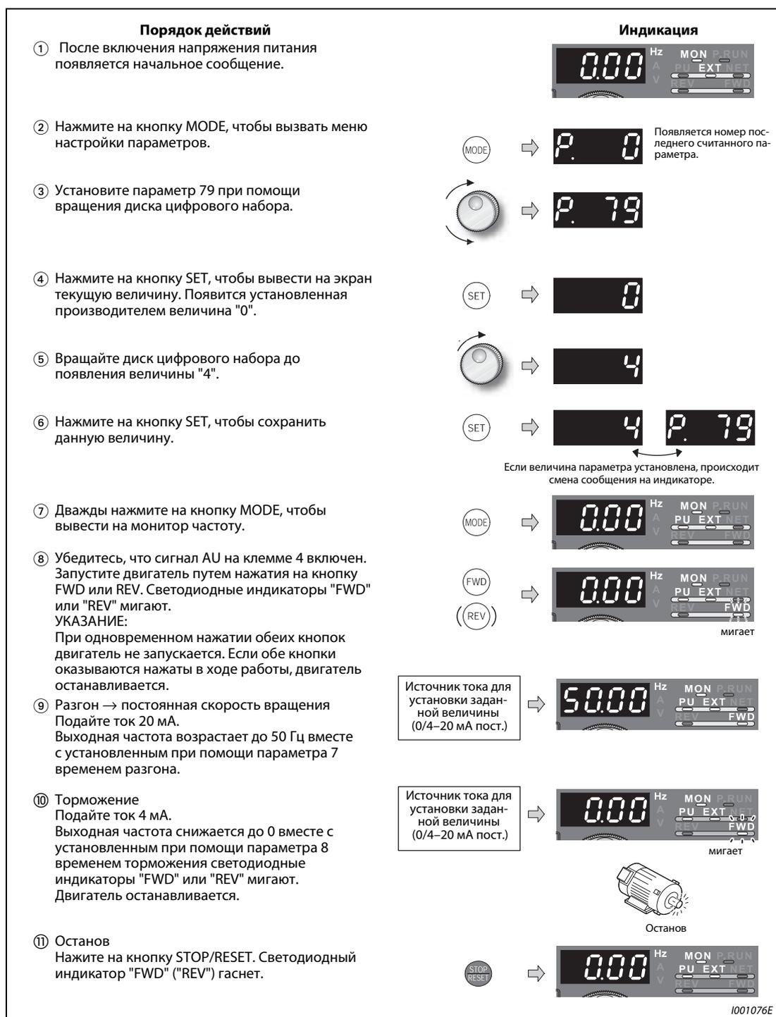
**Рис. 4-20:** Работа преобразователя частоты при аналоговой установке заданной величины тока
