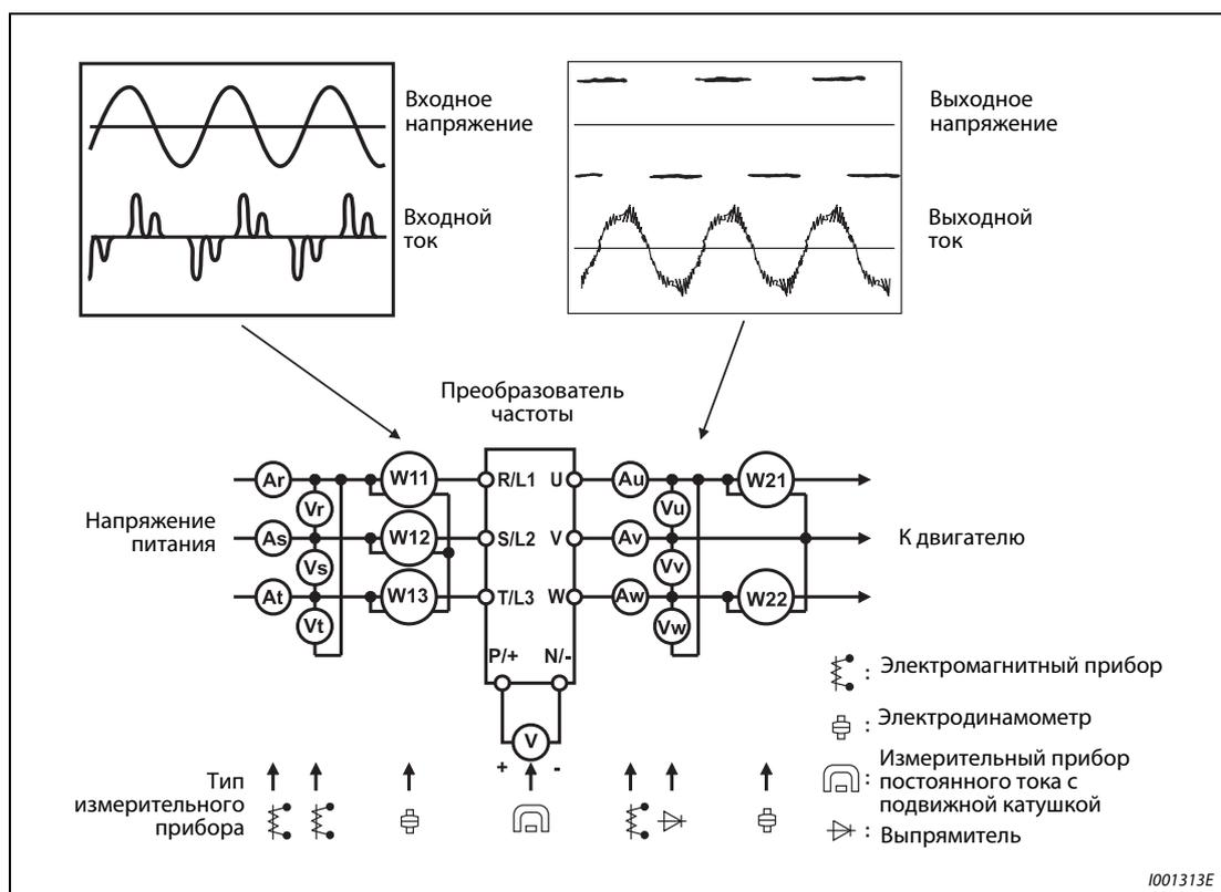
Рис. 7-7: Измерения на блоке питания
