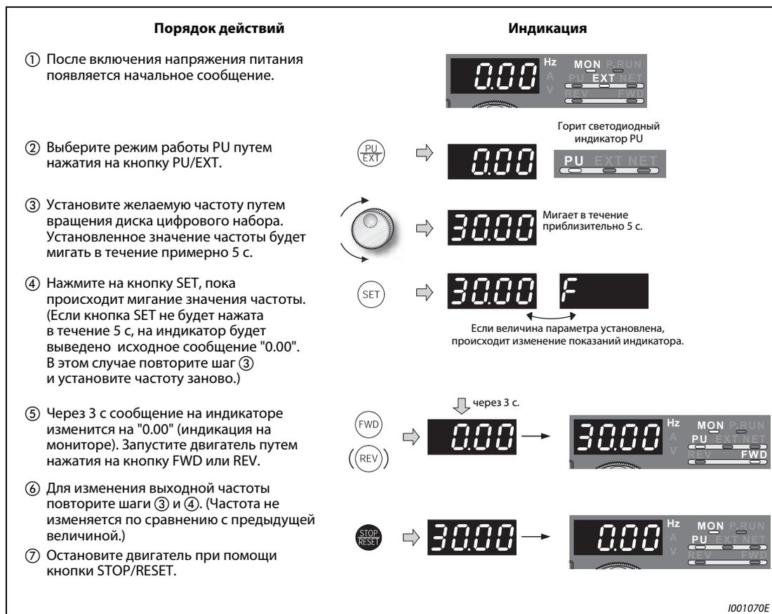
Рис. 4-12: Установка частоты при помощи диска цифрового набора
