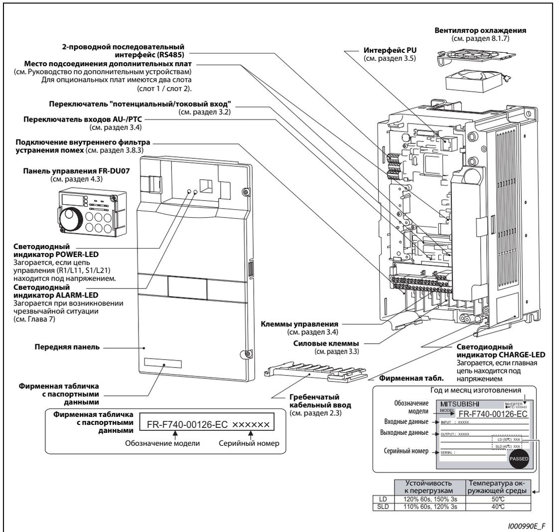
Рис. 1-3: Устройство преобразователя частоты
