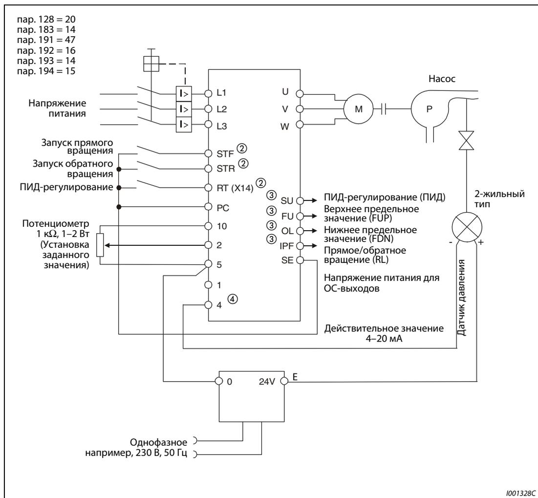
**Рис. 6-180:** Пример подключения при использовании позитивной логики
