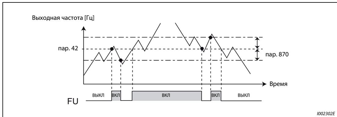
**Рис. 6-69:** Пример сигнала контроля выходной частоты (FU)
