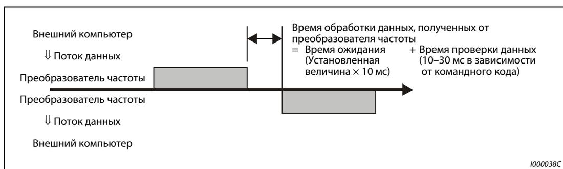
**Рис. 6-159:** Определение времени ожидания**УКАЗАНИЯ**
