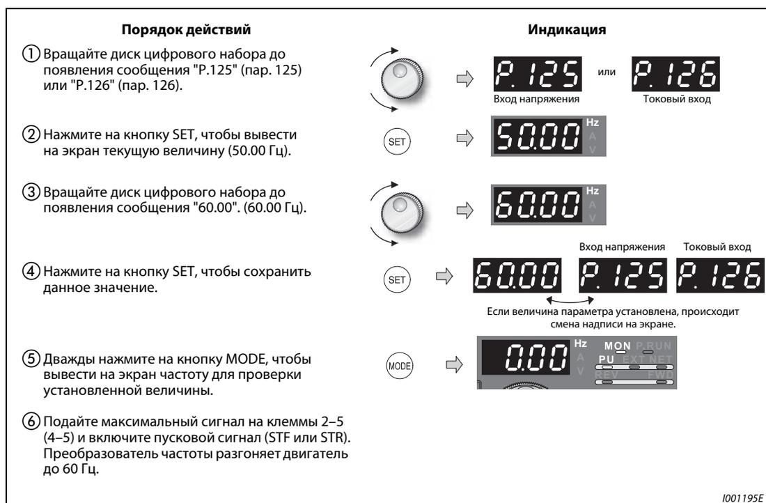
**Рис. 6-124:** Установка частоты без установки напряжения (тока)
