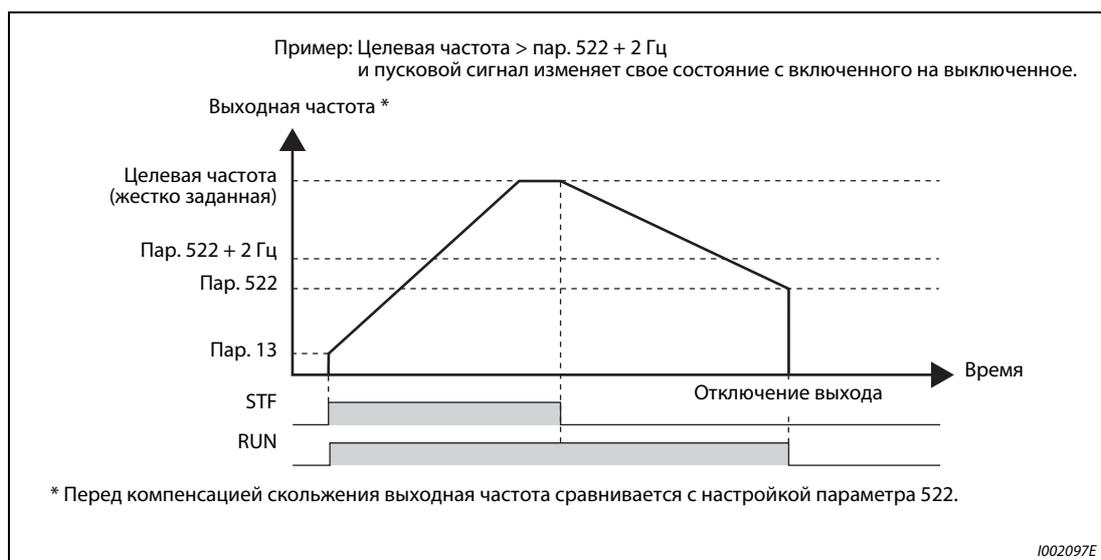
**Рис. 6-55:** Пример 1: Целевая частота > пар. 522 + 2 Гц, пусковой сигнал = ВКЛ./ВЫКЛ.
