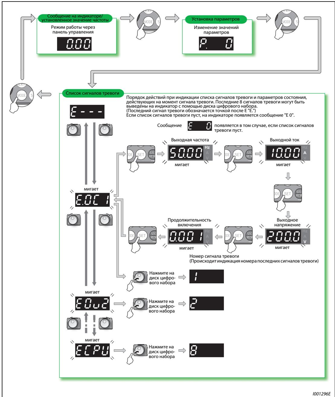
**Рис. 7-5:** Чтение списка сигналов тревоги и параметров состояния, действующих на момент сигнала тревоги
