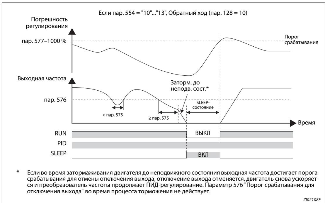
Рис. 6-183: Отключение выхода (функция SLEEP), если пар. 554 = "10" ... "13"
