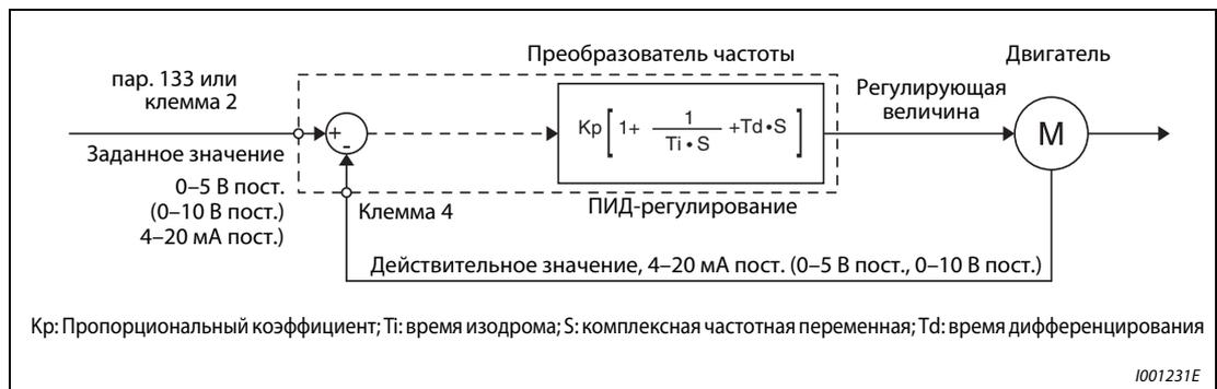
**Рис. 6-174:** Конфигурация системы для пар. 128 (пар. 573) = 20 или 21, 120, 121 (клемма для установки заданного/действительного значения)
