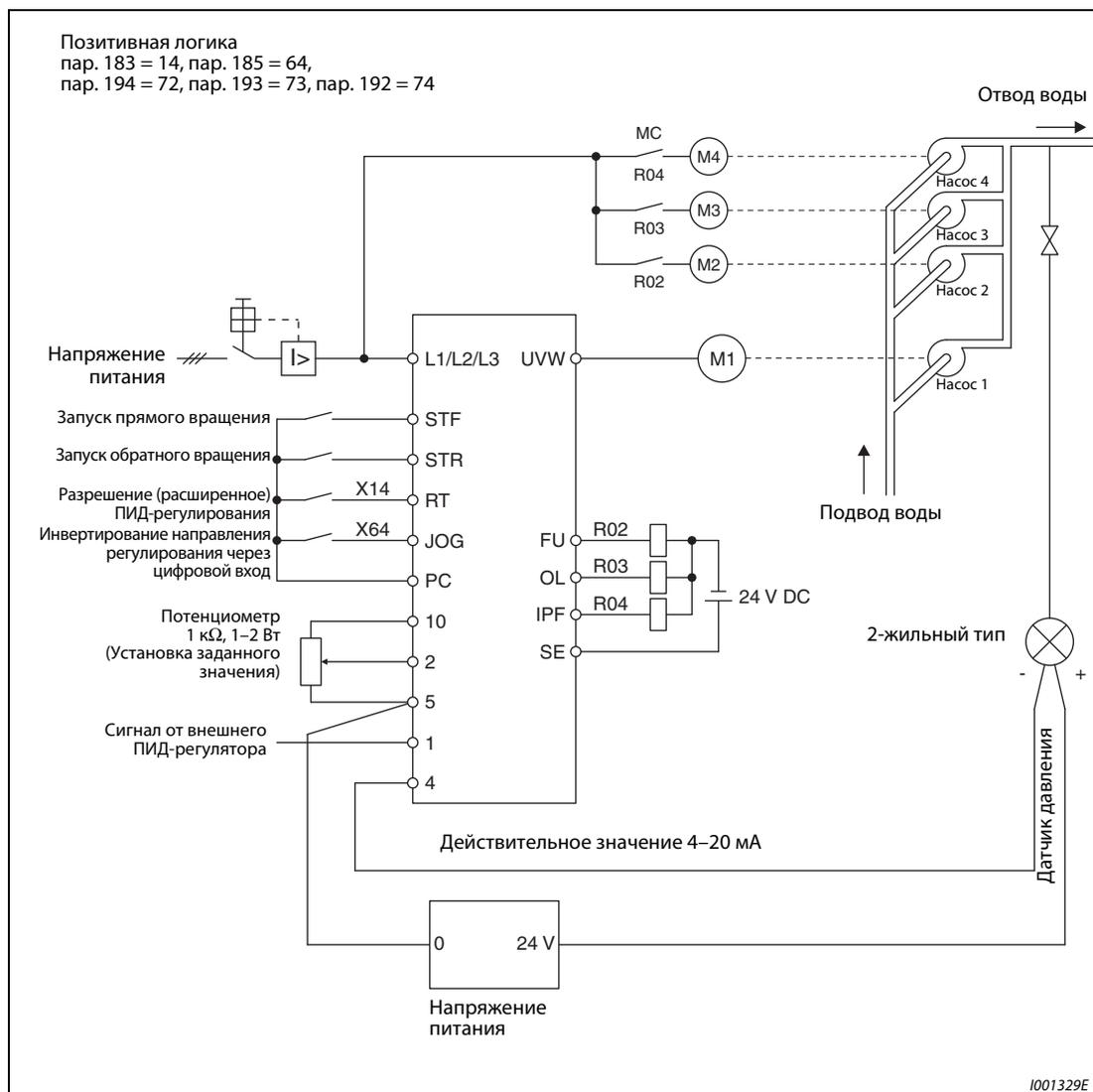
**Рис. 6-197:** Расширенное ПИД-регулирование (стандартный режим работы)
