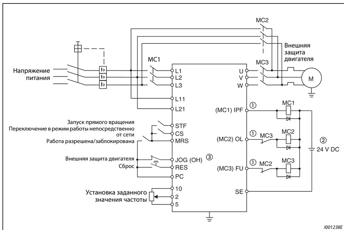
**Рис. 6-208:** Подключение силовых контакторов
