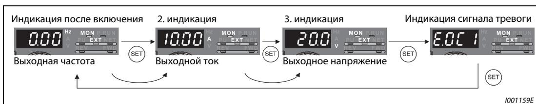
**Рис. 6-76:** Индикация различных рабочих параметров
