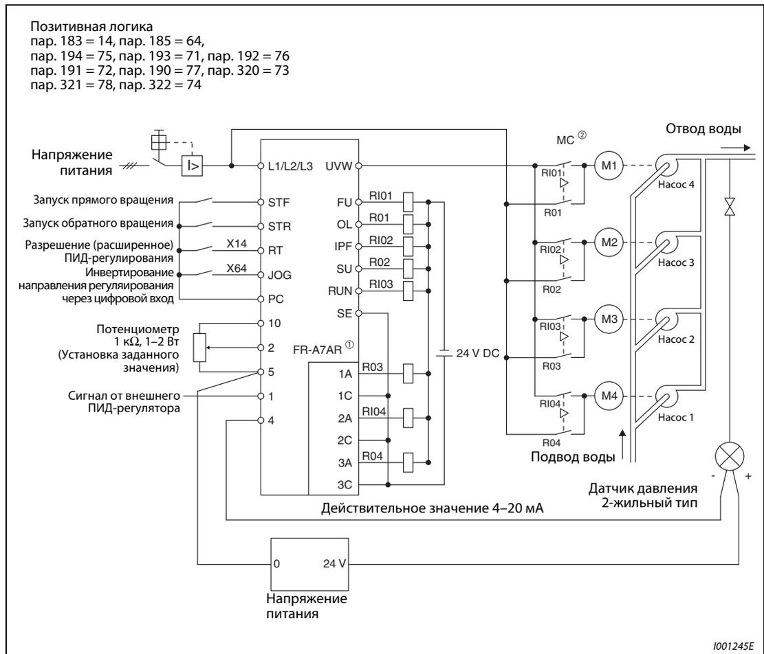
**Рис. 6-198:** Расширенное ПИД-регулирование (переменный режим, режим переключения и комбинированный переменный режим/режим переключения)
