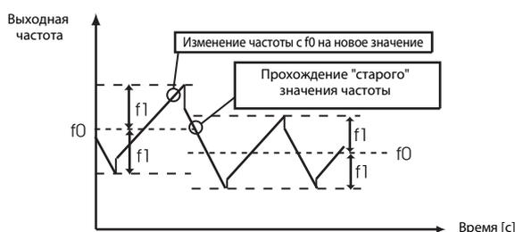
Если выходная частота превышает максимальную частоту, заданную параметром 1, или ее значение находится ниже минимальной частоты, заданной параметром 2, то происходит ее ограничение значениями, заданными параметрами 1 или 2 (пока запрограммированная форма кривой не выйдет за рамки предельных значений)
