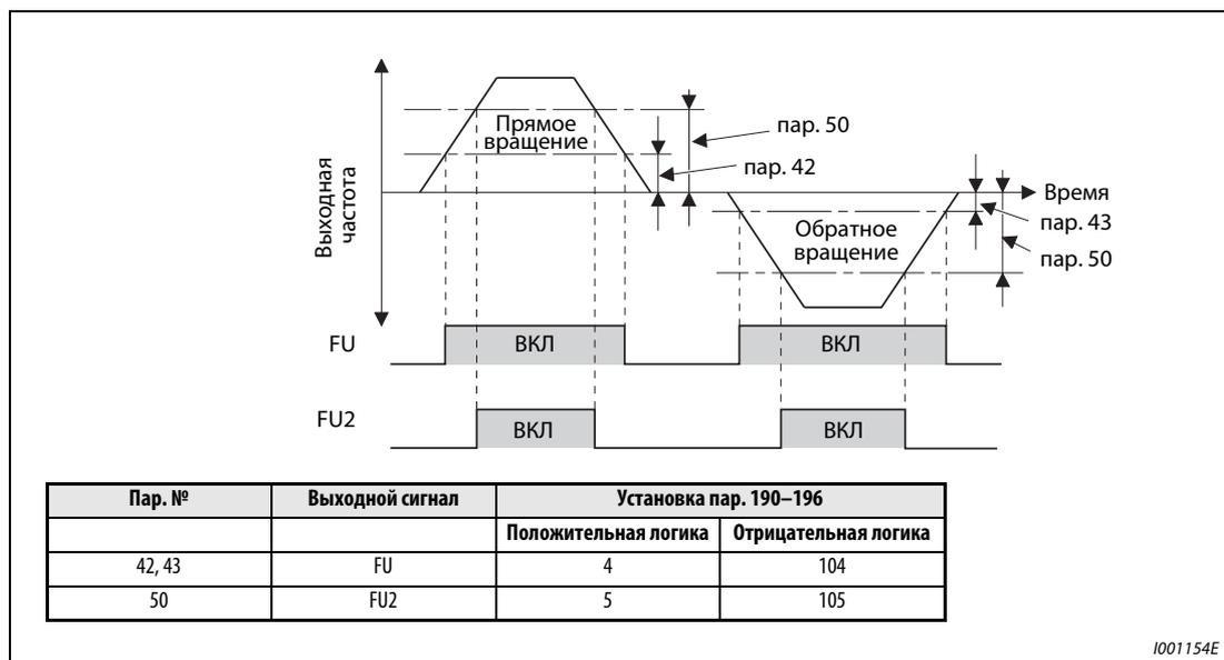
**Рис. 6-68:** Контроль частоты при прямом и обратном вращении
