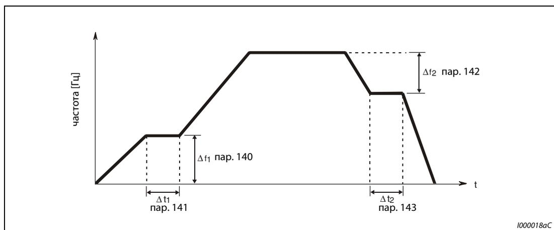
**Рис. 6-37:** Изменения частоты для компенсации зазора редуктора.
