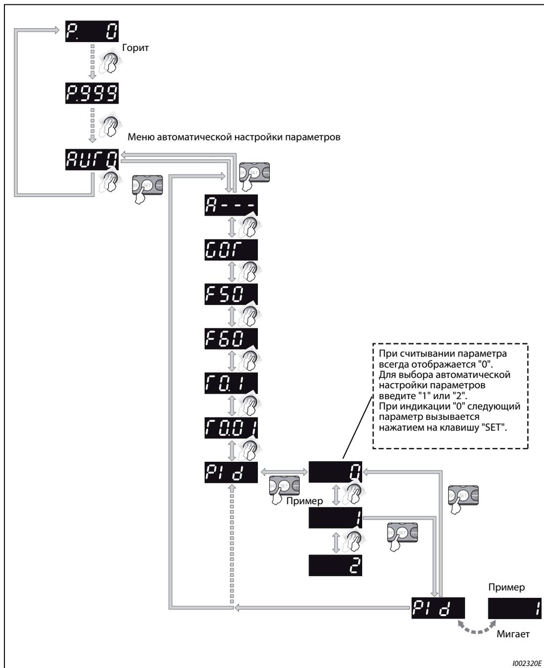
**Рис. 6-224:** Автоматическая настройка параметров
