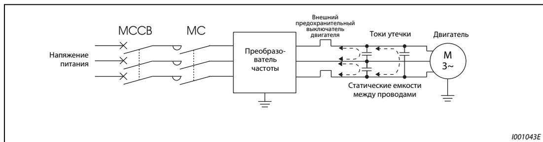
**Рис. 3-36:** Токи утечки между проводами
