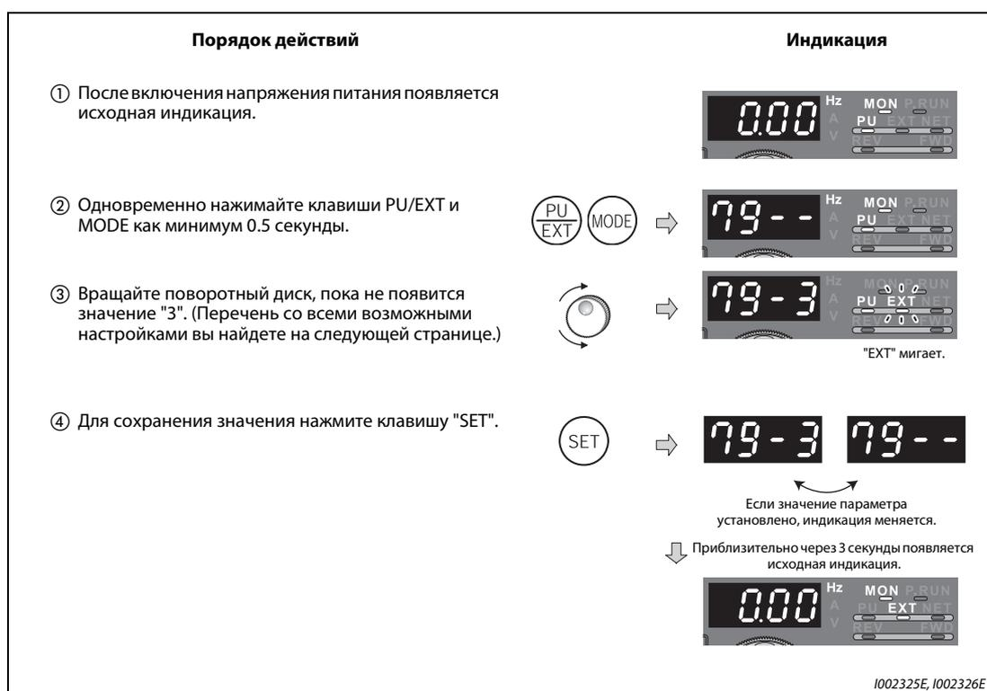
**Рис. 4-5:** Одновременно нажав клавиши PU/EXT и MODE, параметр 79 можно изменить сразу
