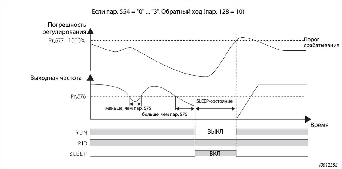
Рис. 6-182: Отключение выхода (SLEEP-функция), если пар. 554 = "0" ... "3"
