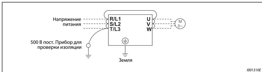
Рис. 8-15: Проверка изоляции по отношению к земле
