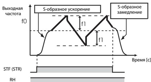
При срабатывании устройства ограничения тока выполнение траверс-функции прерывается и происходит переход в нормальный режим работы. После завершения ограничения тока в течение промежутка времени, заданного параметром 7 или 8, происходит разгон/замедление двигателя до заданного значения частоты  $f_0$ . По достижении заданного значения частоты продолжается выполнение траверс-функции.
