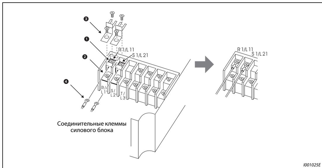
**Рис. 3-15:** Соединительные клеммы
