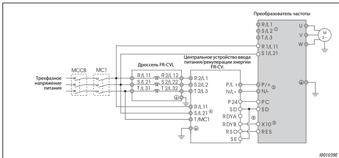
**Рис. 3-32:** Подключение комбинированного устройства рекуперации энергии/сетевого фильтра FR-HC
