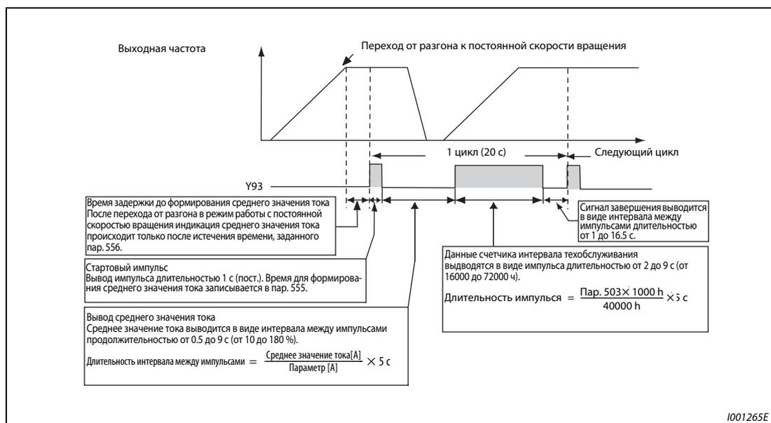
**Рис. 6-220:** Вывод импульсного сигнала Y93
