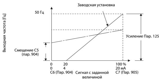
Установку усиления можно также осуществить при токе, поданном в клеммы 4-5 или при отсутствии ввода тока (см. "Установка параметра C7" в разделе 6.15.4).
