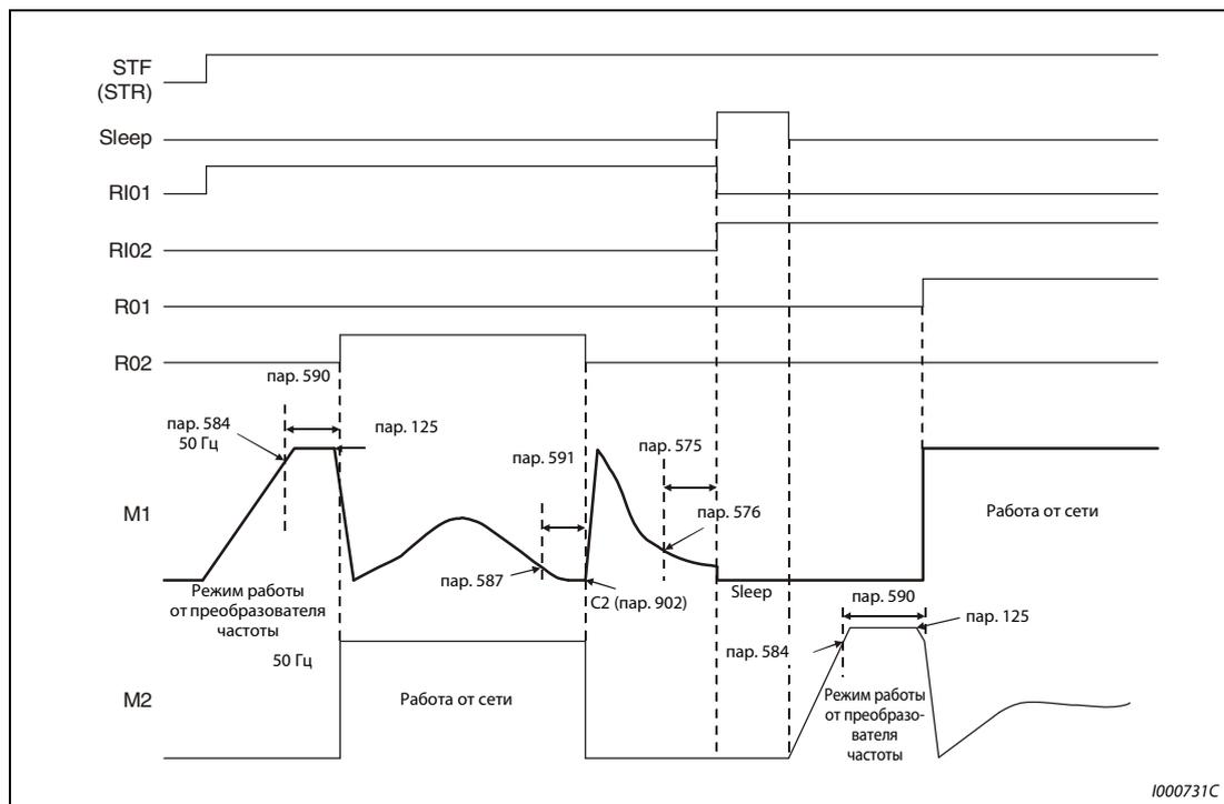
Рис. 6-205: Переходная характеристика при переменном режиме работы
