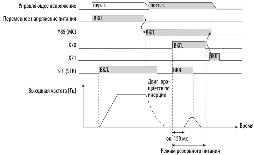
**Пример 2 работы при исчезновении сетевого напряжения (после восстановления напряжения питания)**
