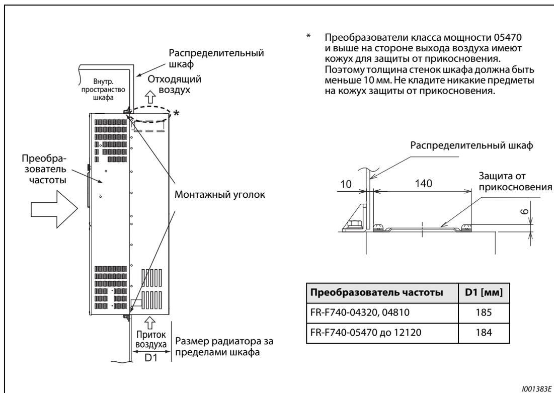
Рис. 2-15: Монтаж преобразователя для вынесенного воздушного охлаждения
