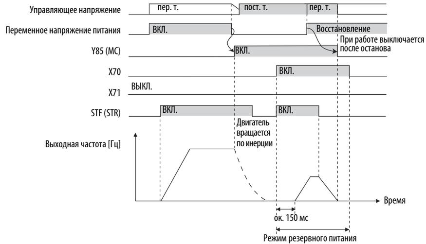
**Пример 3 работы при исчезновении сетевого напряжения (при непрерывной работе)**
