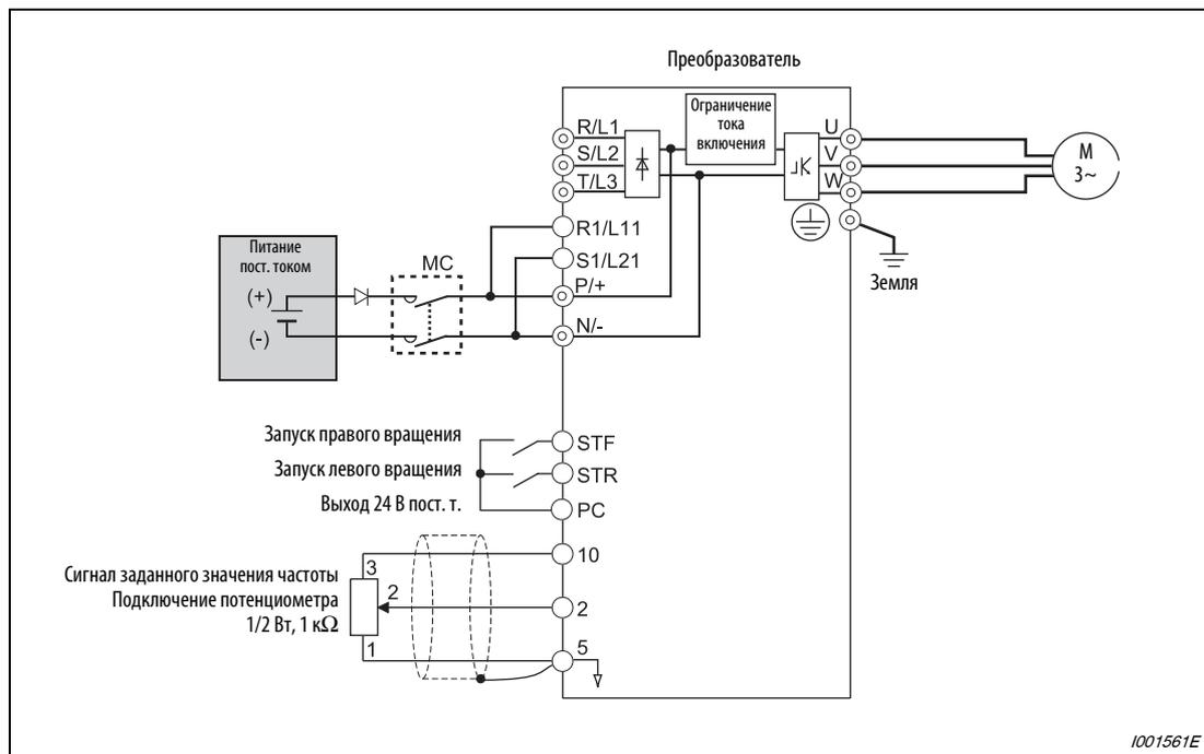
**Рис. 6-49:** Пример подключения для варианта 1 питания контура постоянного тока
