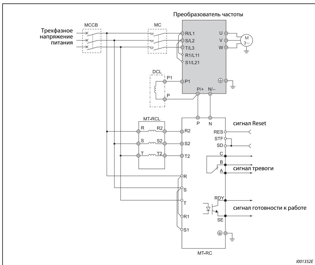
**Рис. 3-33:** Подключение блока рекуперации MT-RC
