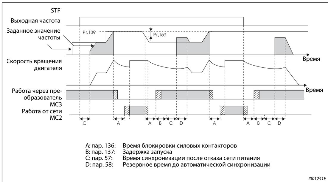
**Рис. 6-211:** *Временная диаграмма сигналов с автоматическим переключением в режим работы от сети*
