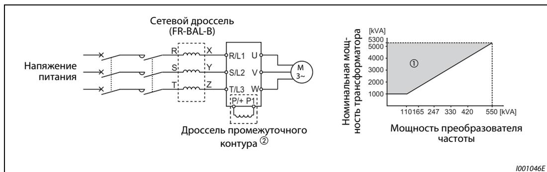
**Рис. 3-35:** Подключение сетевого реактора
