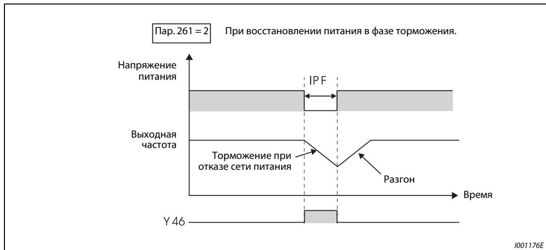
**Рис. 6-97:** Продолжение работы после отключения сети.
