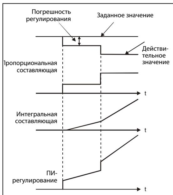
**Рис. 6-175:** Принцип действия ПИ-регулятора
