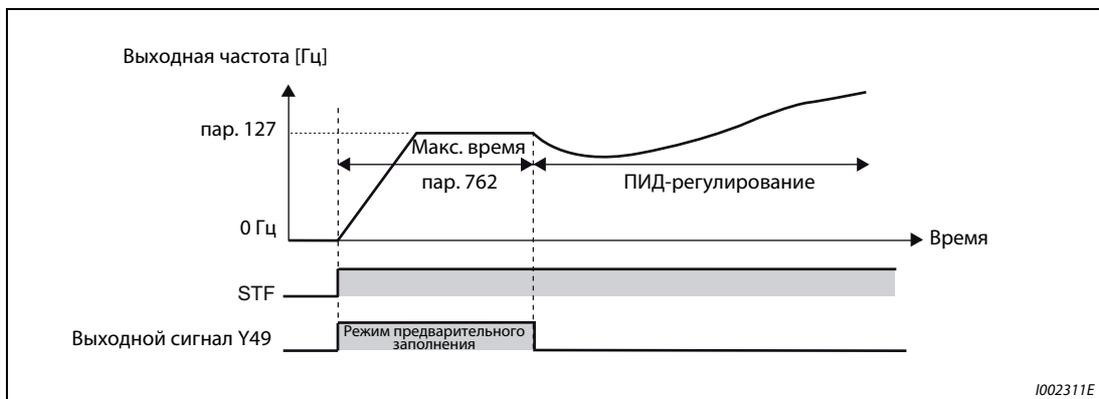
**Рис. 6-189:** Максимальное время режима предварительного заполнения (пар. 762 ≠ 9999)
