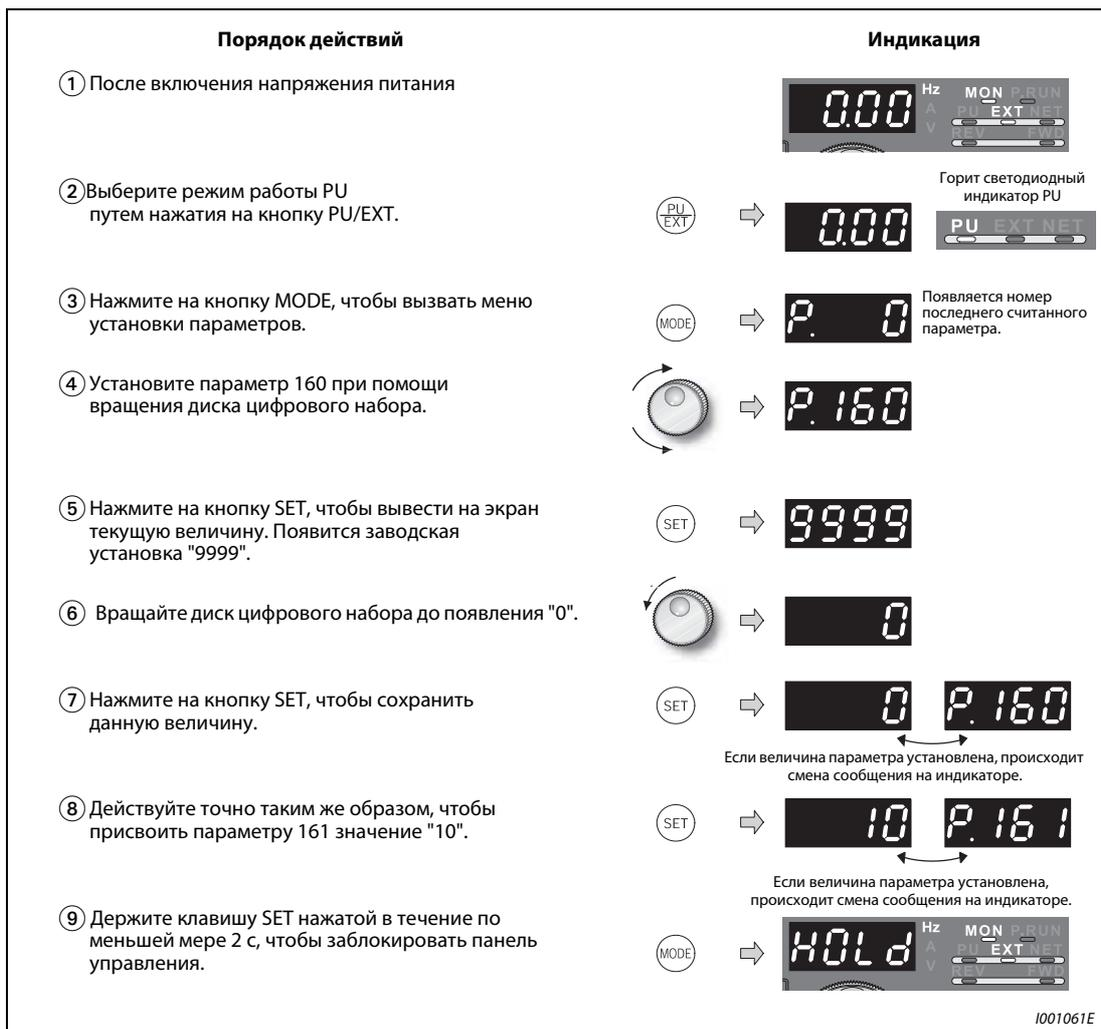
Рис. 4-6: Блокировка панели управления
