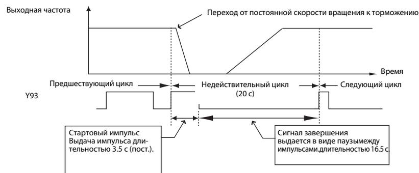
Если выходной ток (величина выходного тока на индикаторе) по завершении первого цикла равен 0 А, до следующего перехода в режим работы с постоянной скоростью вращения дальнейший вывод сигнала Y93 не производится.
