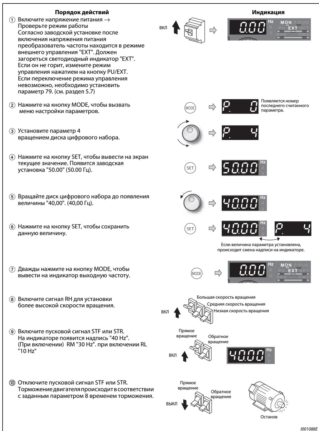
**Рис. 4-25:** Управление работой преобразователя частоты при помощи внешних сигналов
