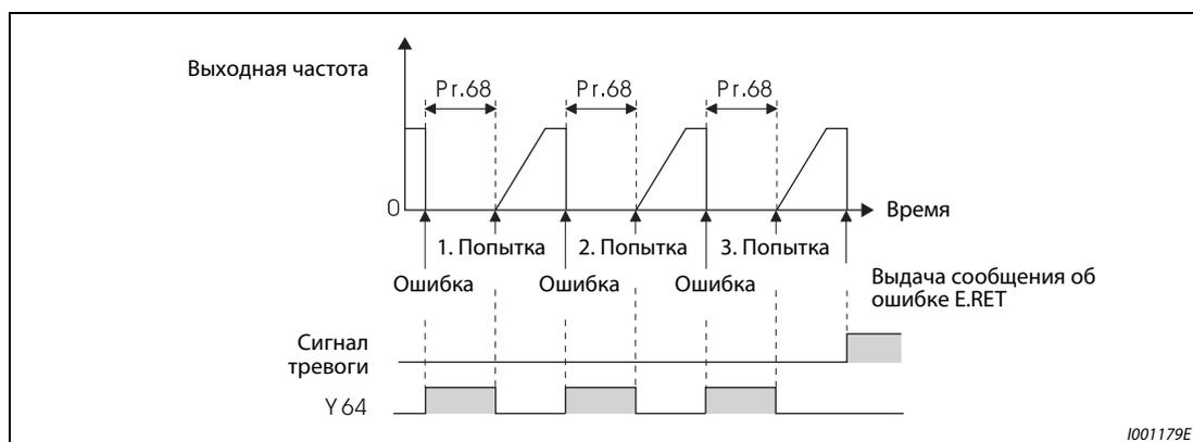
Рис. 6-103: Пример неудачных попыток перезапуска
