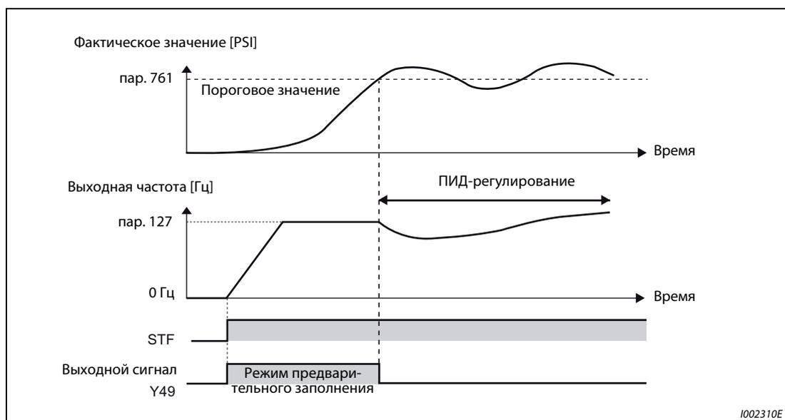
**Рис. 6-188:** Пороговое значение для завершения режима предварительного заполнения (пар. 761 ≠ 9999)
