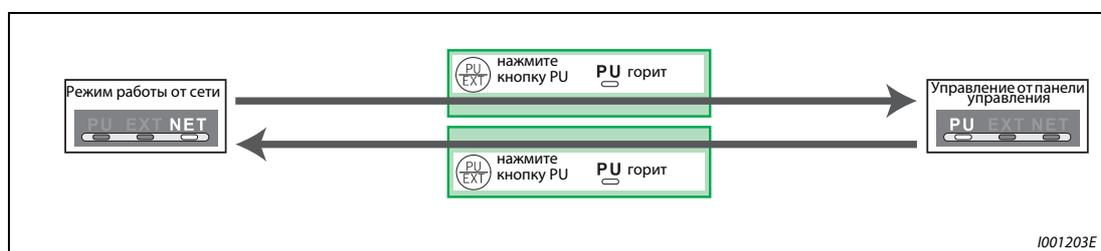
Рис. 6-137: Переключение режима работы при пар. 340 = 10 или 12
