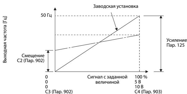
Установку напряжения можно также осуществить при напряжении, приложенном к клеммам 2-5 или при отсутствии напряжения (см. установку параметра C4 в разделе 6.15.4).
