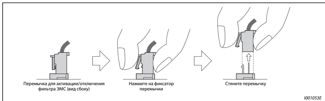
Рис. 3-42: Включение внутреннего фильтра ЭМС
