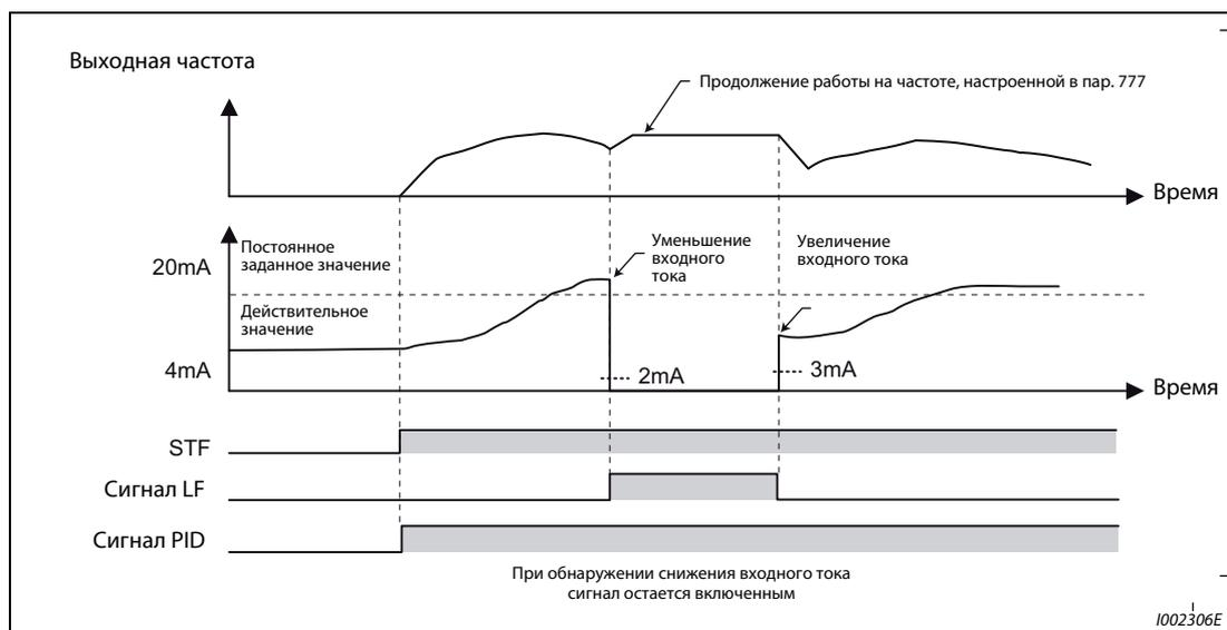
**Рис. 6-131:** Потеря токового заданного значения при ПИД-регулировании (Задний ход, пар. 573 = 4)
