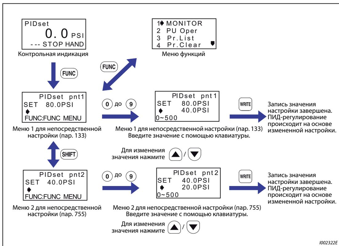
Рис. 6-228: Процесс непосредственной настройки заданного значения ПИД-регулирования
