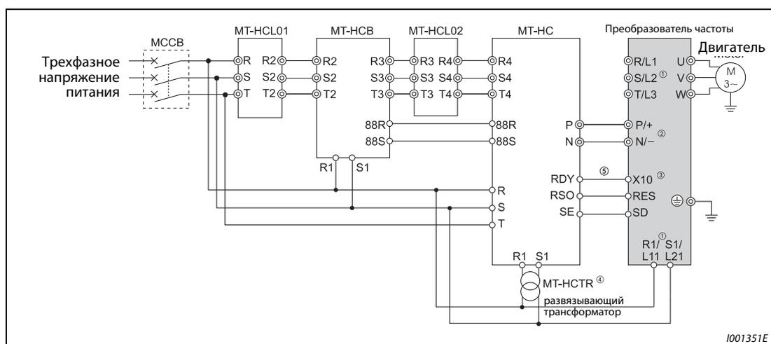
**Рис. 3-31:** Подключение комбинированного устройства рекуперации энергии/ сетевого фильтра MT-НС
