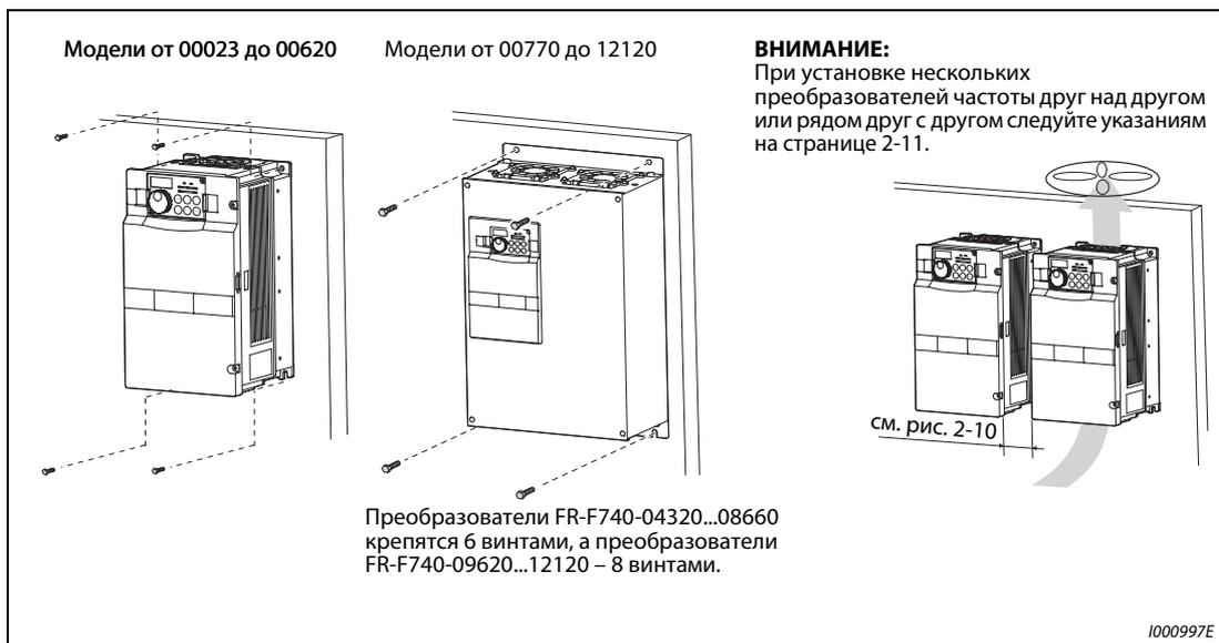
**Рис. 2-8:** Установка на монтажной плате шкафа управления
