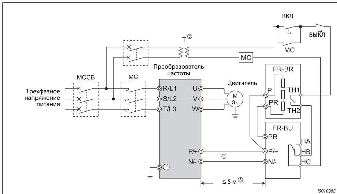
Рис. 3-26: Подключение тормозного устройства типа FR-BU
