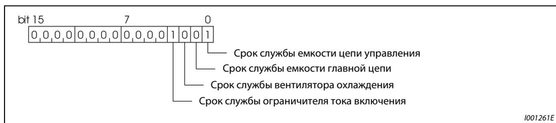
Рис. 6-217: Присваивание бит параметра 255
