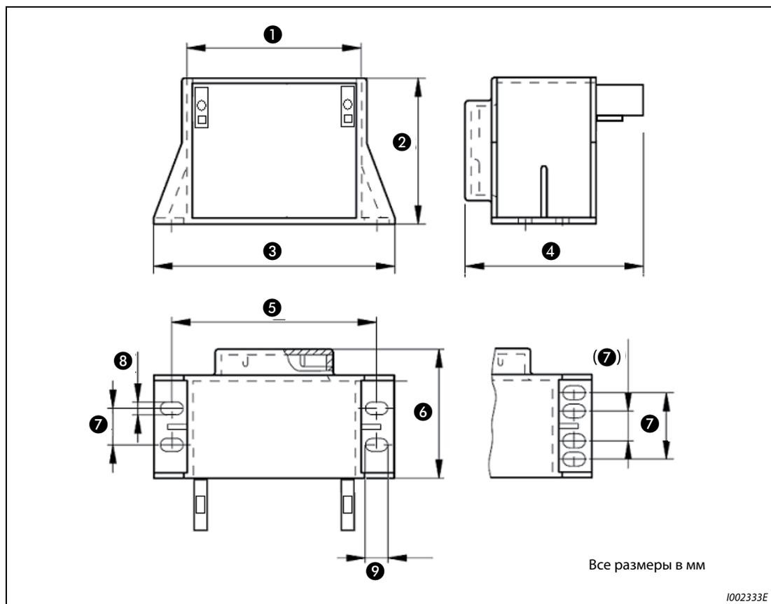
Рис. А-16: Размеры исполнения с заливкой
