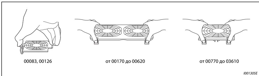
**Рис. 8-4:** Снятие крышки вентилятора
