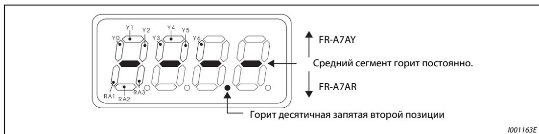
**Рис. 6-80:** *Индикация при установленном дополнительном устройстве FR-A7AY или FR-A7AR*
