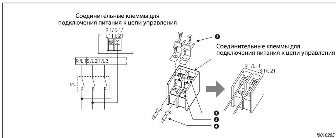
**Рис. 3-16:** Соединительные клеммы
