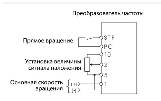
**Рис. 6-117:** Пример схемы для осуществления процентного наложения
