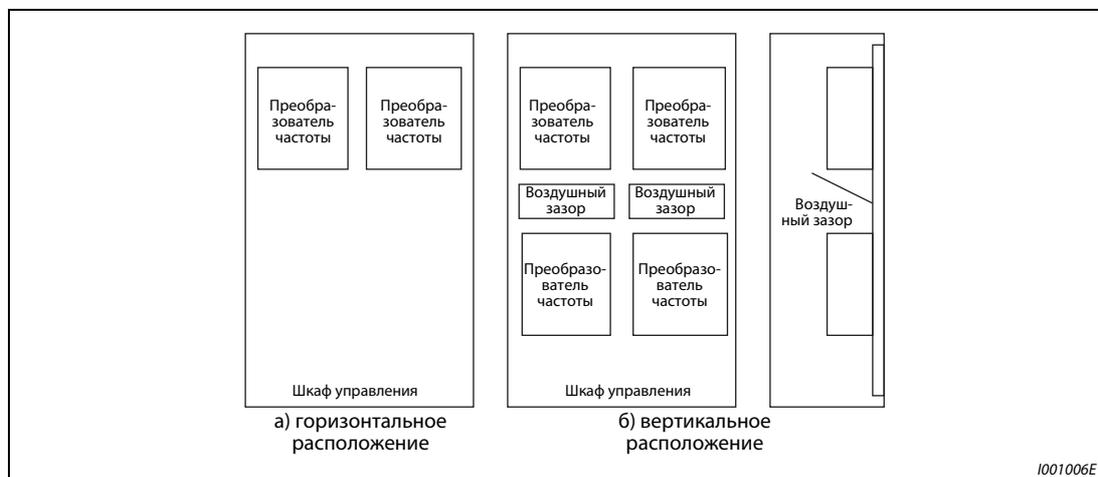
Рис. 2-11: Размещение при установке нескольких преобразователей частоты
