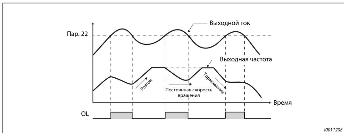
Рис. 6-2: Принцип работы функции токоограничения
