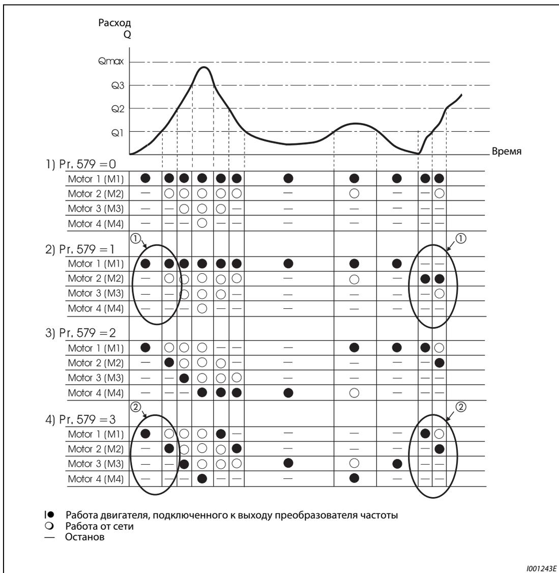
Рис. 6-196: Регулирование расхода жидкости через вспомогательные двигатели
