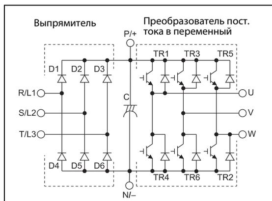
**Рис. 8-3:** Обозначение диодных и транзисторных модулей
