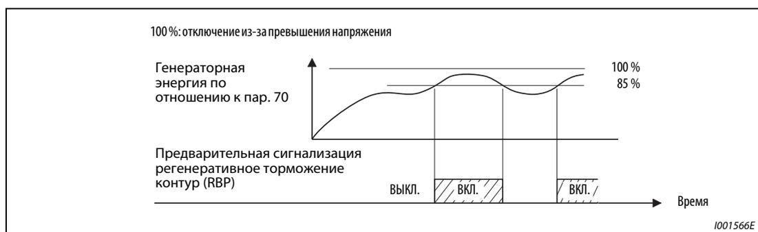
**Рис. 6-52:** Генераторная перегрузка
