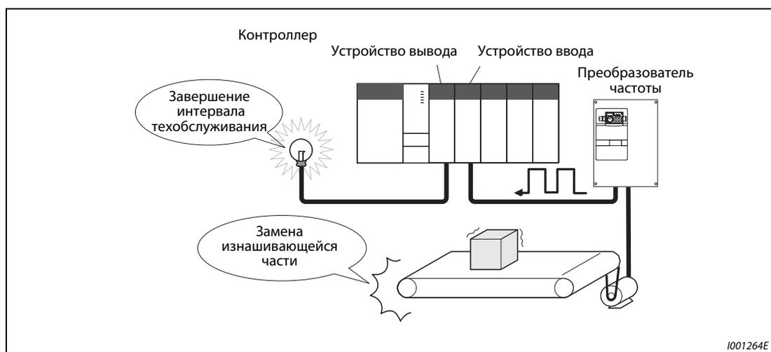
Рис. 6-219: Контроль интервалов техобслуживания и среднего значения тока
