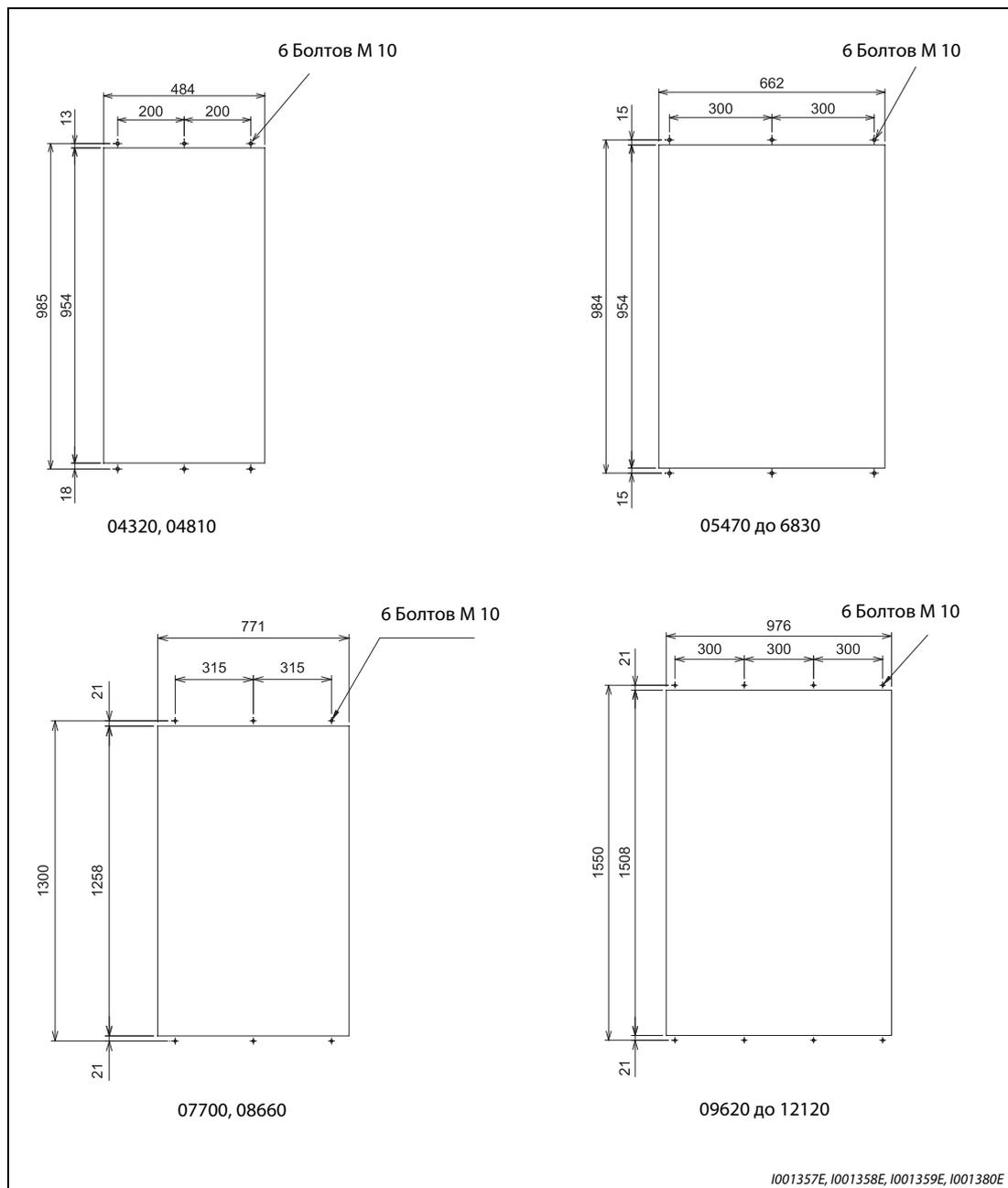
Рис. А-18: Размеры проема в распределительном шкафу
