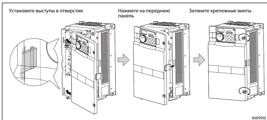
**Рис. 2-3:** Установка передней панели
