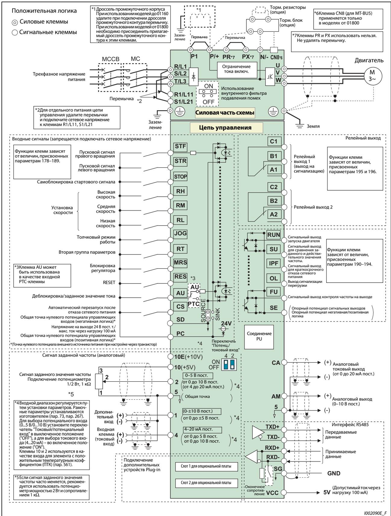
Рис. 3-3: Схема подключения преобразователя частоты
