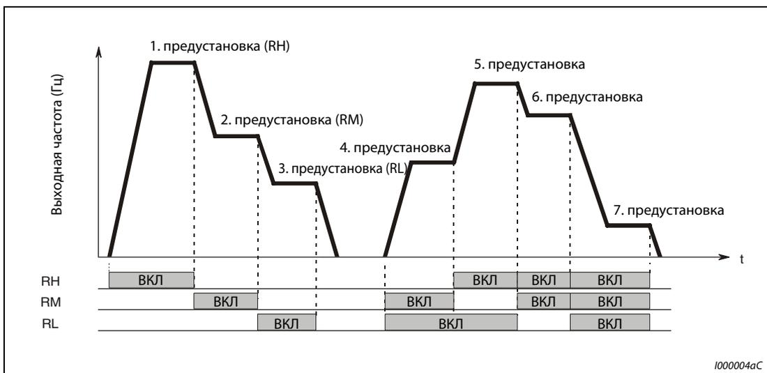
**Рис. 4-24:** Вызов предустановок скорости в зависимости от наличия сигналов на клеммах
