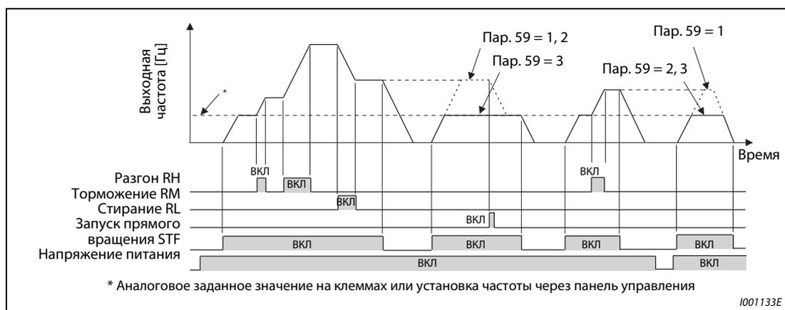
Рис. 6-26: Пример работы цифрового потенциометра двигателя (1)
