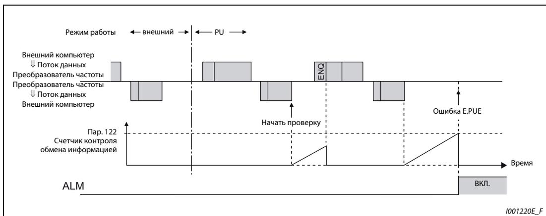
**Рис. 6-163:** Контроль кабеля на разрыв
