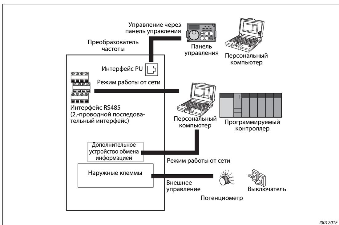
**Рис. 6-135:** Режимы работы преобразователя частоты
