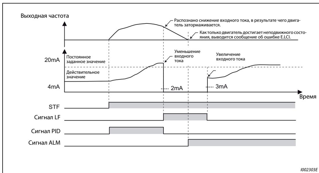
**Рис. 6-128:** Потеря токового заданного значения при ПИД-регулировании (Задний ход, пар. 573 = 3)
