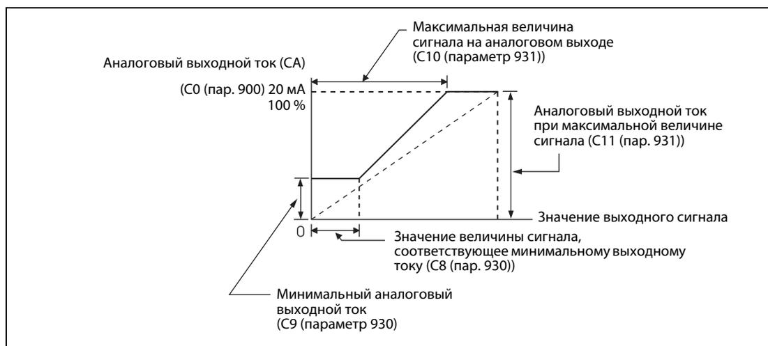
**Рис. 6-84:** Калибровка выхода СА
