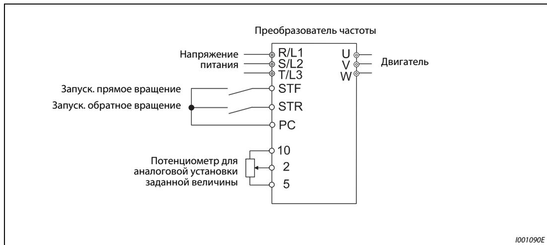
**Рис. 4-26:** Аналоговая установка заданного значения напряжения через потенциометр
