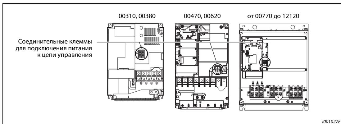
**Рис. 3-17:** Положение соединительных клемм
