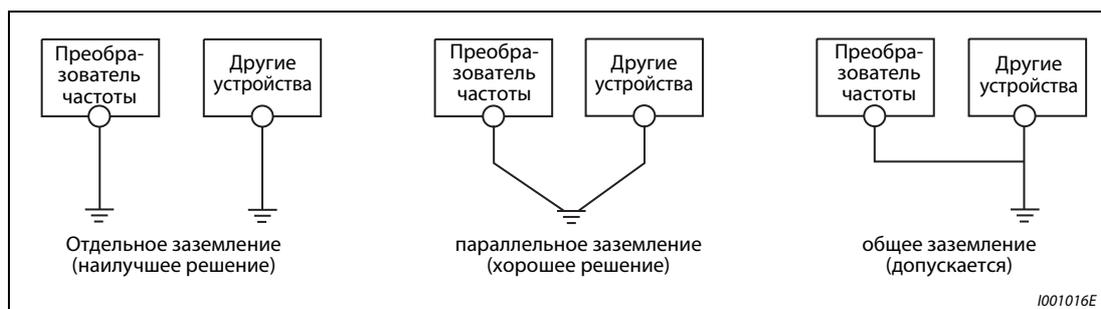
**Рис. 3-6:** Заземление приводной системы
