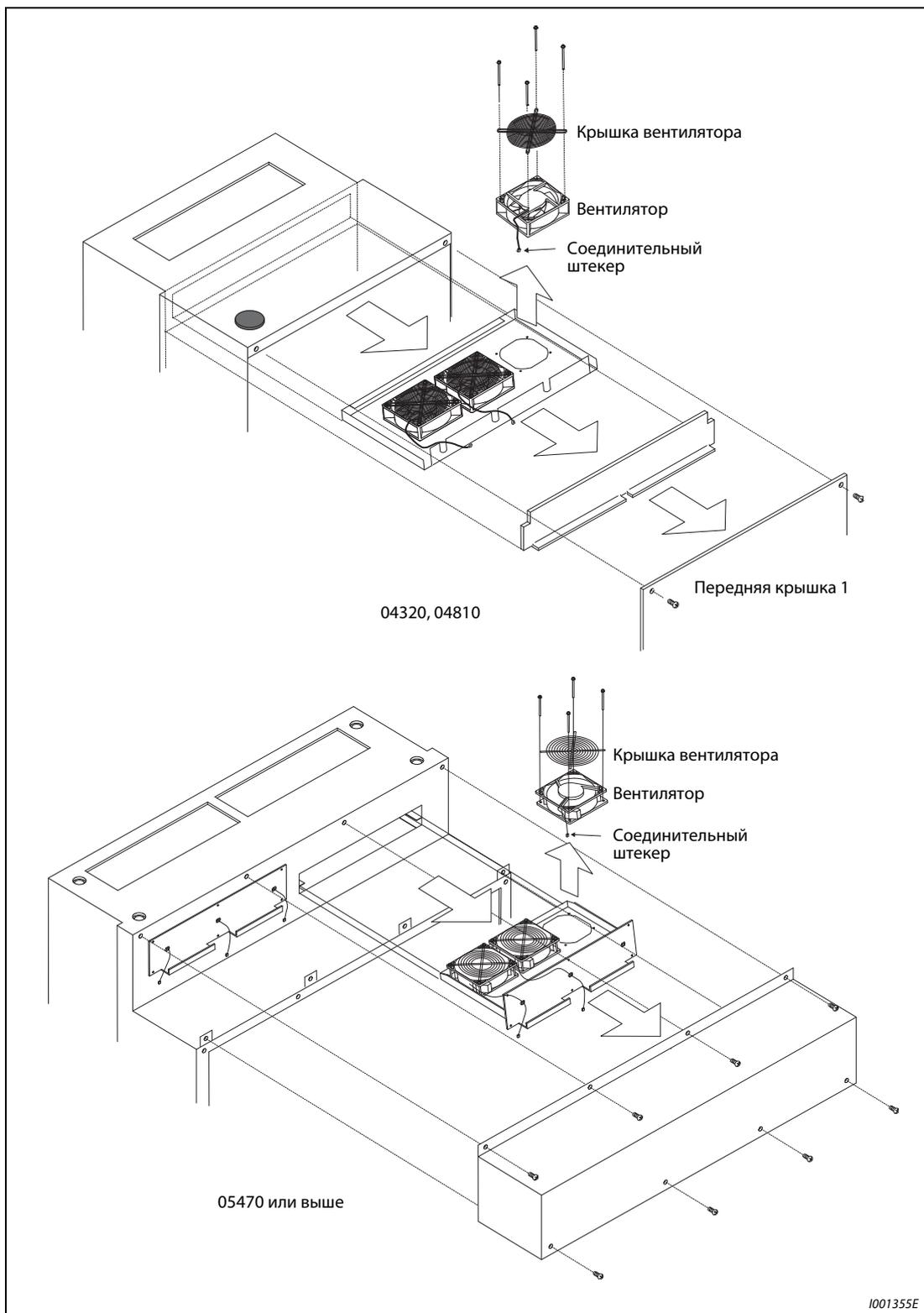
**Рис. 8-9:** Демонтаж вентилятора охлаждения
