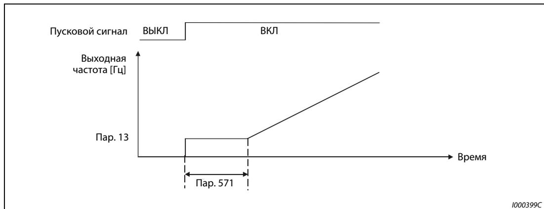
**Рис. 6-33:** *Время удержания стартовой частоты*
