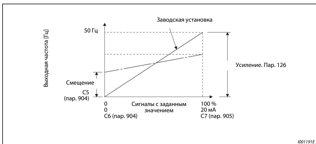
**Рис. 6-121:** Подгонка сигнала на клемме 4
