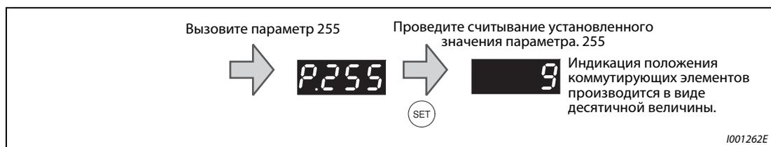
**Рис. 8-1:** Считывание параметра 255
