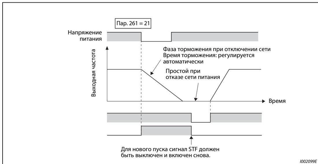
Рис. 6-99: Режим останова при исчезновении сетевого напряжения
