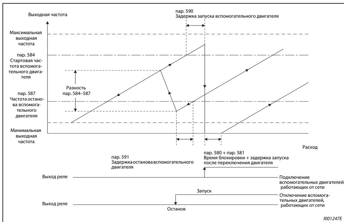
**Рис. 6-200:** Схема последовательности действий при запуске и останове вспомогательного двигателя 1
