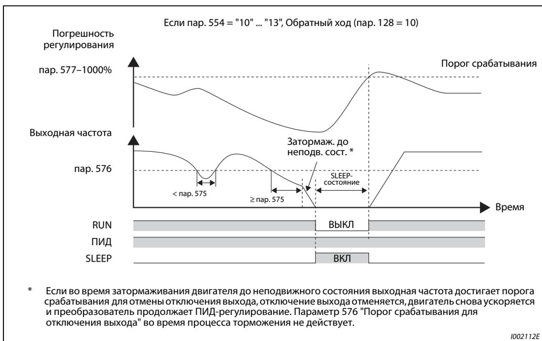
Рис. 6-203: Отключение выхода (функция SLEEP), если пар. 554 = "10" ... "13", пар. 128 = "10 "
