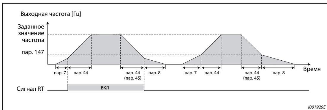
**Рис. 6-31:** Автоматическое переключение времени разгона/торможения
