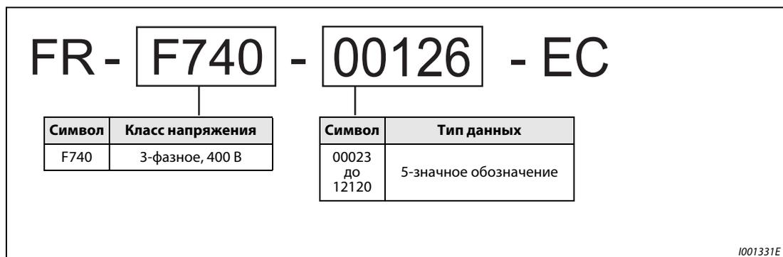
Рис. 1-1: Обозначение модели
