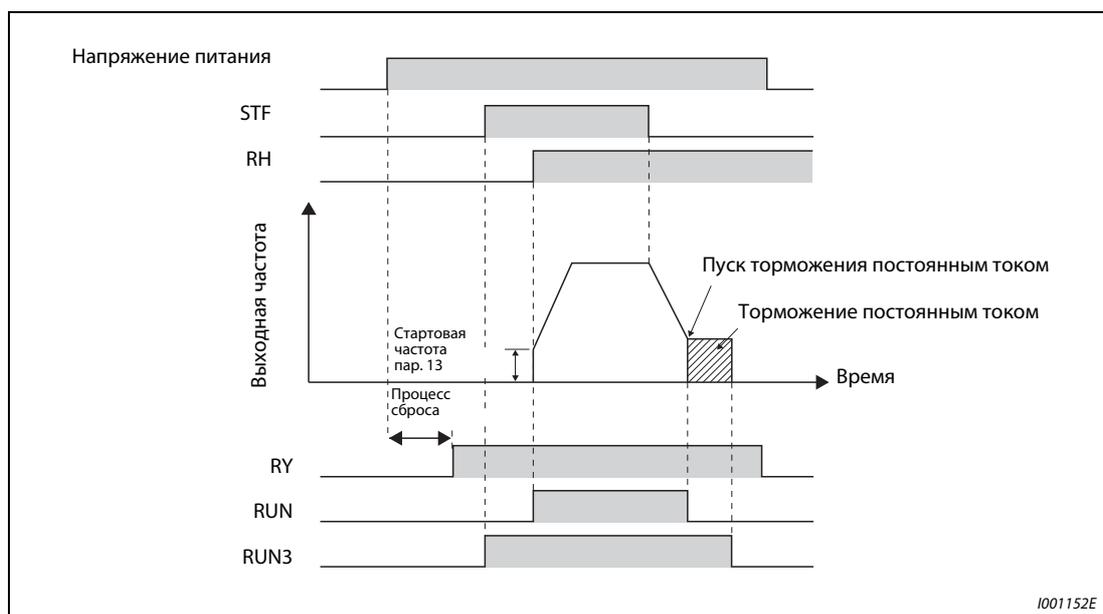
**Рис. 6-65:** Готовность к работе и работа двигателя
