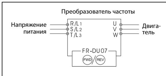
**Рис. 6-23:** Пример подключения для толчкового режима с управлением от панели управления
