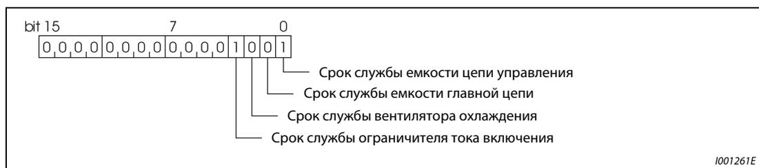
**Рис. 8-2:** Присваивание битов параметра 255
