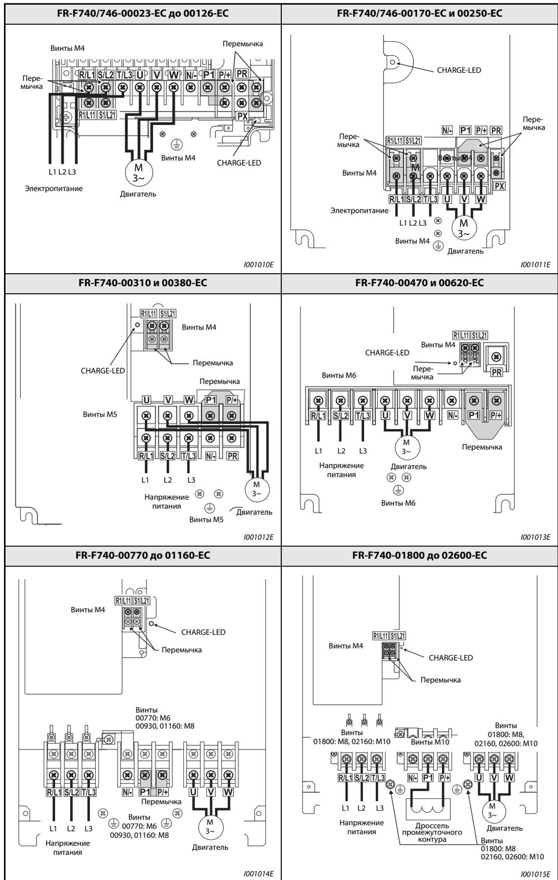
Таб. 3-3: Расположение клемм и проводные соединения (1)
