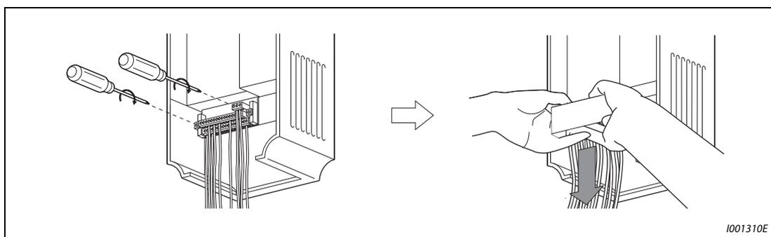
**Рис. 8-13:** Снятие клеммного блока
