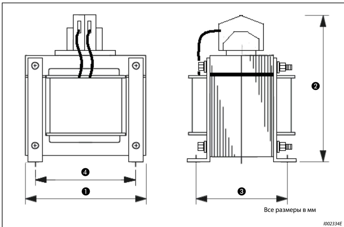
**Рис. А-17:** Размеры исполнения без заливки
