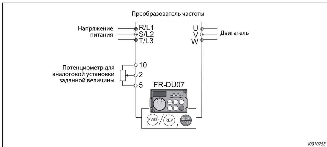
**Рис. 4-17:** Аналоговая установка заданного значения напряжения при помощи потенциометра
