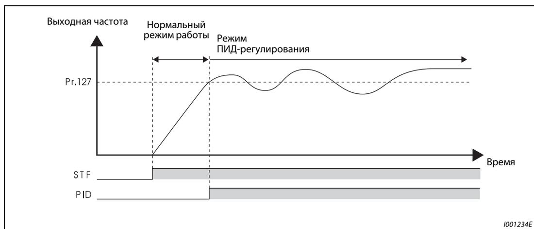
Рис. 6-181: Автоматическое переключение в режим ПИД-регулирования.
