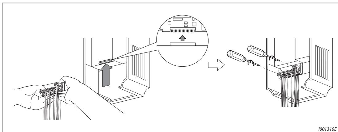
**Рис. 8-14:** Установка клеммного блока
