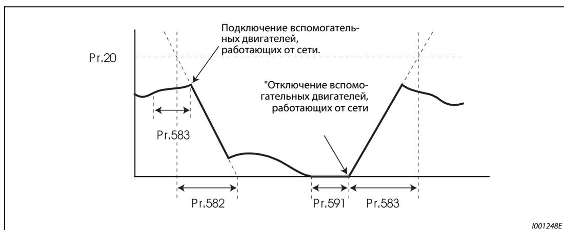
Рис. 6-201: Время торможения/разгона
