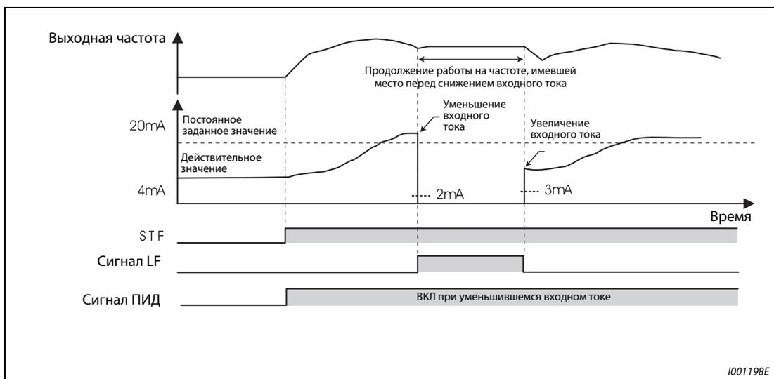
**Рис. 6-127:** Уменьшение заданного значения тока при ПИД-регулировании (обратный ход, пар. 573 = 1)
