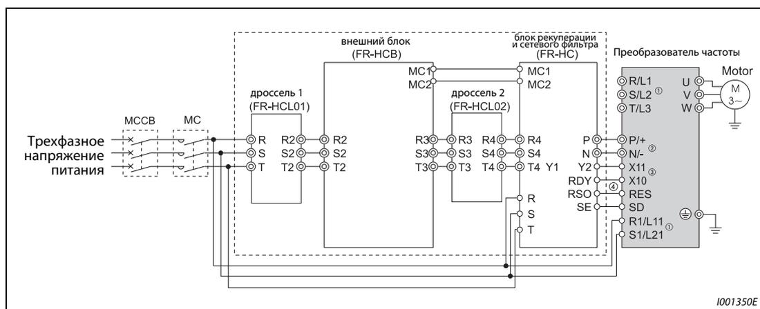
**Рис. 3-30:** Подключение комбинированного устройства рекуперации энергии/сетевого фильтра FR-НС
