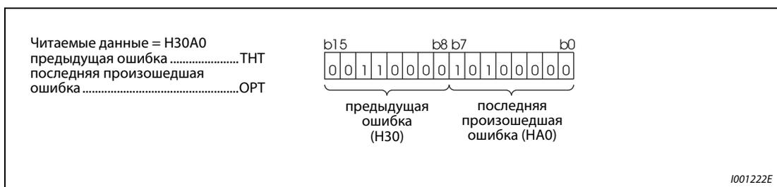
**Рис. 6-166:** Пример аварийной сигнализации
