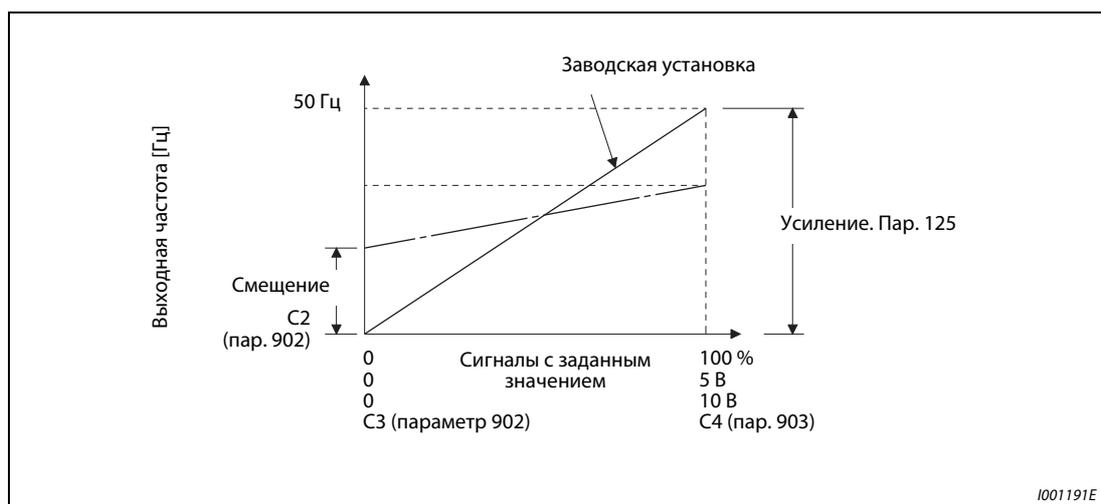
**Рис. 6-120:** Подгонка сигнала на клемме 2
