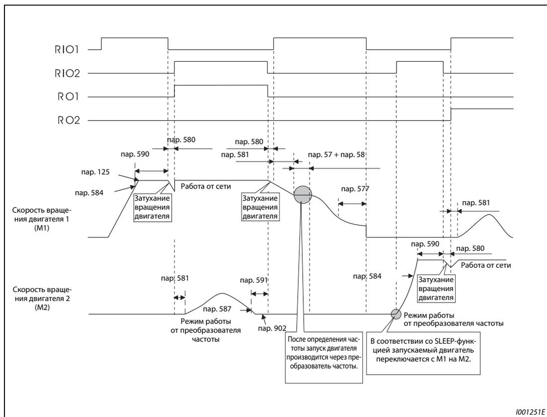
Рис. 6-207: Переходная характеристика в переменном режиме/режиме переключения
