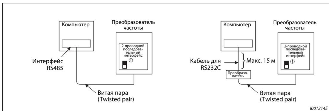
**Рис. 6-149:** Кабельное соединение с преобразователем частоты
