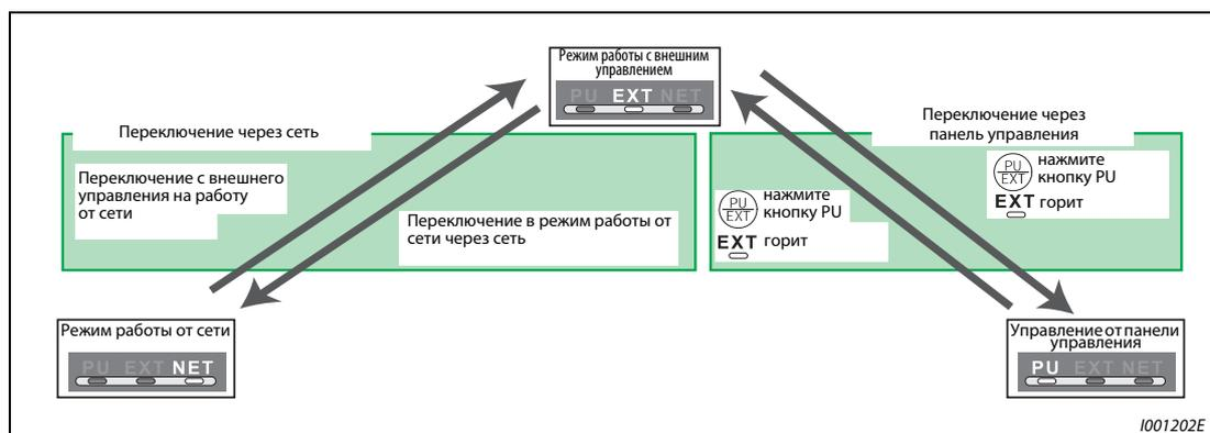
Рис. 6-136: Переключение режима работы при пар. 340 = 0, 1 или 2
