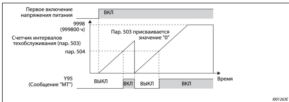
Рис. 6-218: Счетчик интервалов техобслуживания
