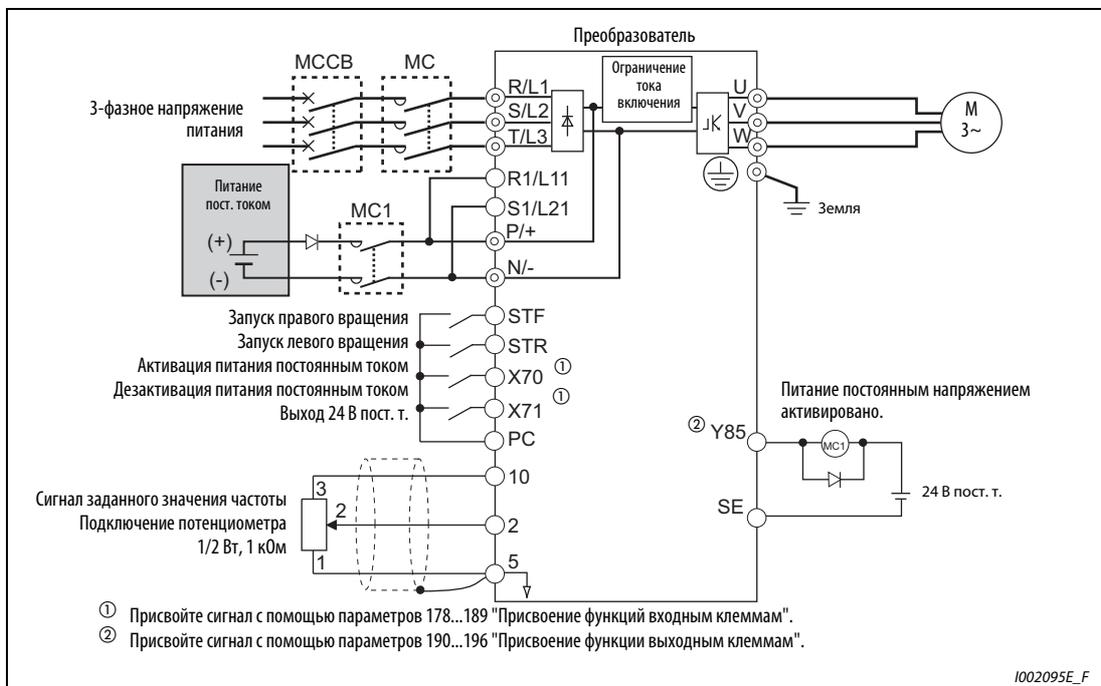
**Рис. 6-50:** Пример подключения для варианта 2 питания контура постоянного тока
