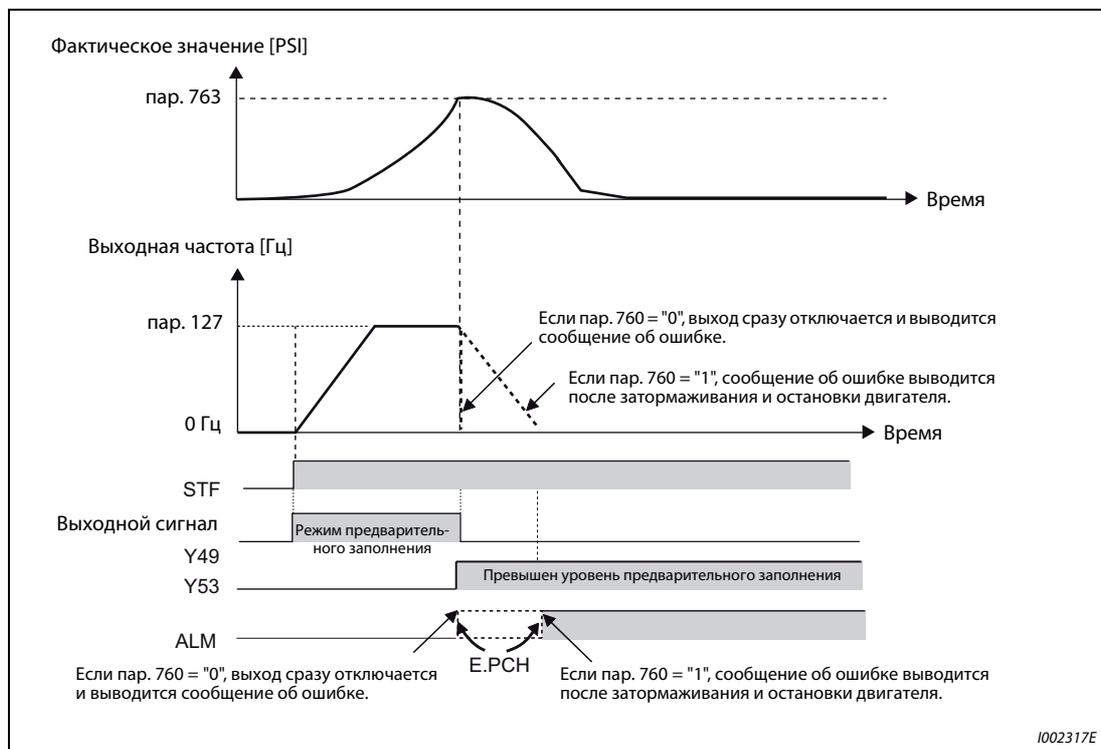
**Рис. 6-195:** Достижение предельного фактического количества в режиме предварительного заполнения
