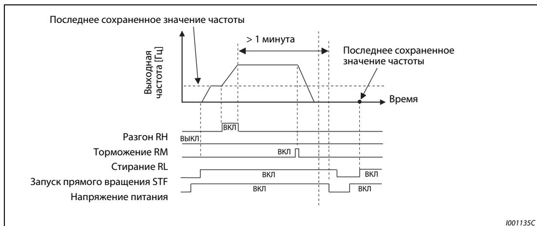
Рис. 6-29: Выдача частоты с текущим значением
