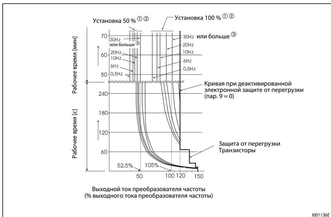
**Рис. 6-39:** Характеристики защиты двигателя
