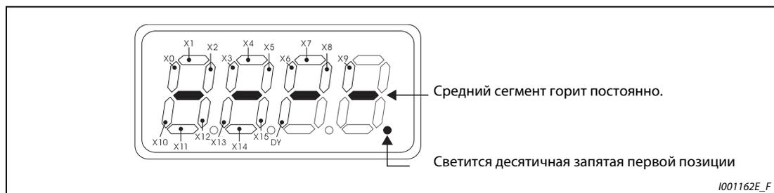
**Рис. 6-79:** *Индикация при установленном дополнительном устройстве FR-A7AX*
