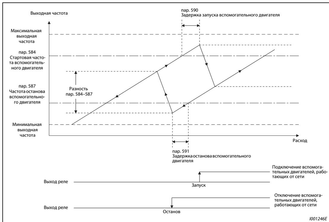
**Рис. 6-199:** Схема последовательности действий при запуске и останове вспомогательного двигателя 1
