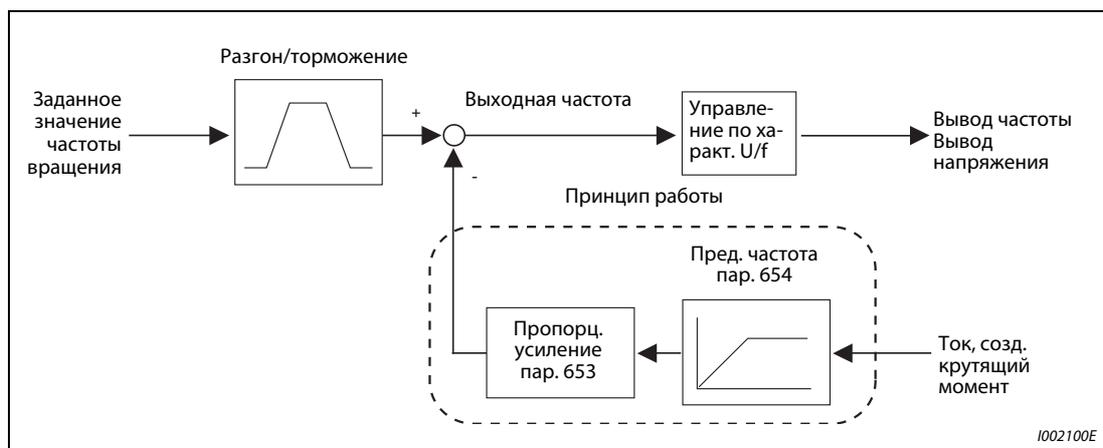
Рис. 6-106: Принцип подавления вибрации
