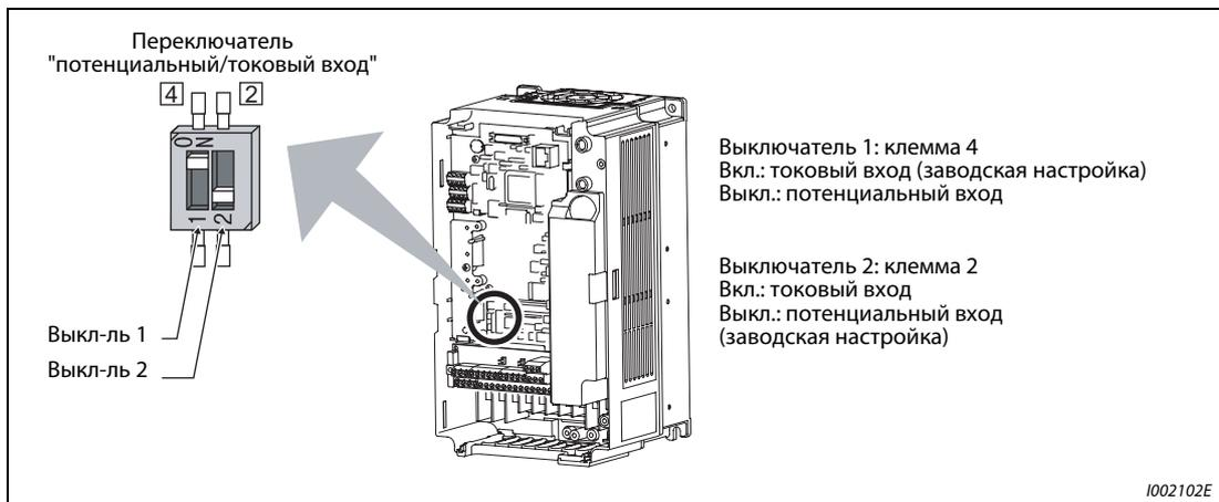
**Рис. 6-108:** Переключатель "Потенциальный/токовый вход"
