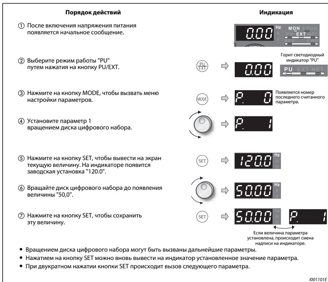
Рис. 5-4: Установка максимальной выходной частоты
