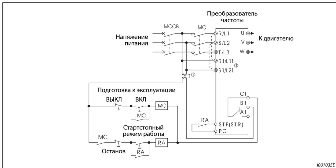
**Рис. 3-25:** Запуск и останов преобразователя частоты
