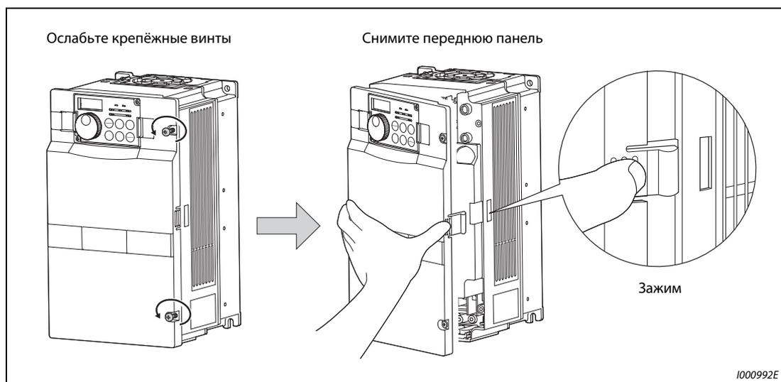
**Рис. 2-2:** Снятие передней панели
