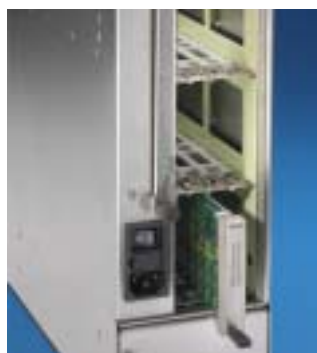
Пространство монтажа для 6 АМС, 1 x МСН
