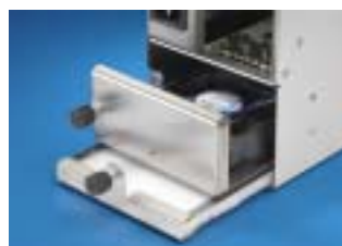
Блок вентиляторов и фильтр, выдвижной
