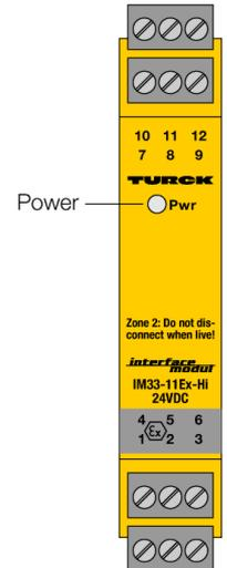
Одноканальный HART® преобразователь IM33-11EX-HI/24VDC с гальванической развязкой служит для подключения искробезопасных HART® 2-х проводных преобразователей (III) во взрывоопасной зоне и передачи измеряемого сигнала в безопасную. В дополнение к аналоговым сигналам, преобразователь также передаёт цифровые сигналы HART® связи в обоих направлениях.
