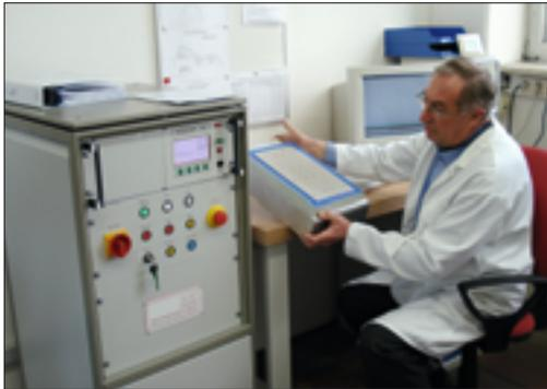
Der Messplatz besteht aus einem geschirmten Prüfraum mit eingebauten Hochspannungskomponenten.
