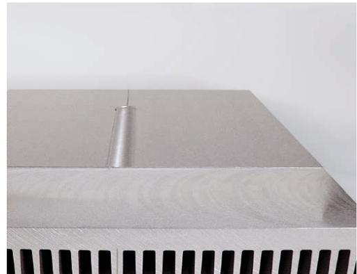
Keine sichtbare Schweißnaht nach dem Überfräsen
