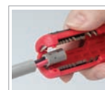
Stripping low volt cable
