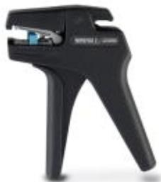
Инструмент для снятия изоляции, для проводов и кабелей сечением от 0,08 до 2,5 мм, саморегулирующийся, длина зачищаемой части провода до 15 мм, режущая способность: жесткие провода до 1,5 мм<sup>2</sup>, гибкие провода до 6 мм<sup>2</sup>
