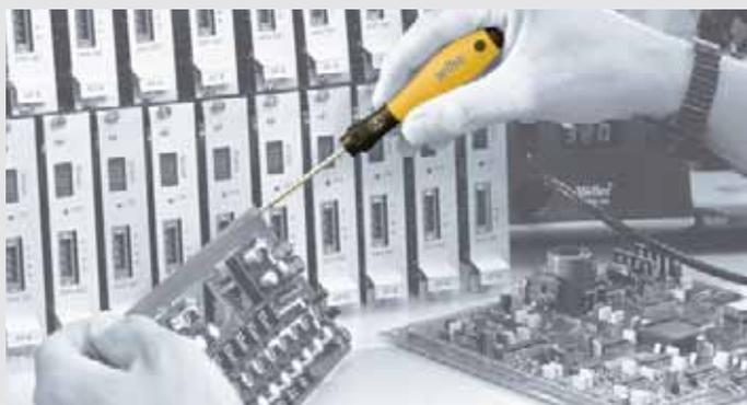
Твердая сердцевина рукоятки изготовлена из ударовезкого полипропилена. Поверхность изготовлена из приятного на ощупь термопластичного эластомера, который обеспечивает удобный и надежный захват без проскальзывания. Покрытие жестко соединено с сердцевиной рукоятки при помощи литья под давлением. Высококачественные жала из хром-ванадий-молибденовой
