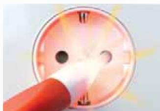
Пробник распознает фазу и нулевой провод.
