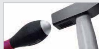
Модель с шестигранным жалом, шестигранником под гаечный ключ и массивным стальным набалдашником идеально подходит для откручивания сильно зажатых винтов.
