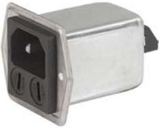
5707, Montage: Schraub, front-/rückseitig, Filter: Standard- und Medizinalversion, Sicherungshalter: 1- / 2-polig, frontseitig, 8 A, PA / Silikon / Stahl Gerätestecker: IEC C14, Geeignet für Geräte der Schutzklasse I oder II
