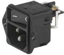
DC11, Montage: Schraub, Wippenschalter: unbeleuchtet oder beleuchtet 1- / 2-polig, Steckanschlüsse 4.8 x 0.8 mm, Gerätestecker: IEC C14, Ohne Sicherungshalter: Geeignet für Geräte der Schutzklasse I oder II
