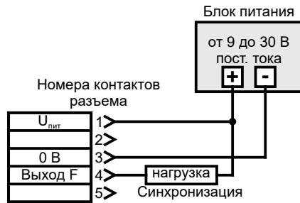
Рисунок 7 – Схема подключения *mic+.../F/TC* (подключение по схеме NPN)
