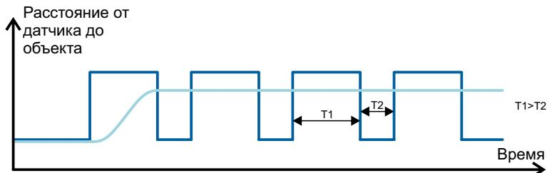
Рисунок 30 — Алгоритм работы датчика с усредняющим фильтром
