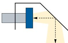
*Рисунок 39 – Перенаправление ультразвуковой волны с помощью отражателя*
