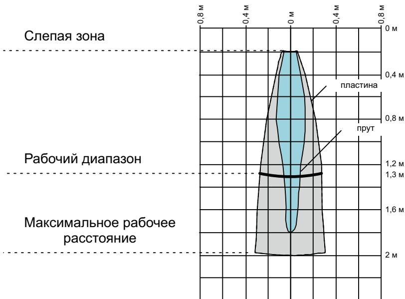
Рисунок 42 – Зона распространения ультразвуковой волны датчика *mic+130/...*
