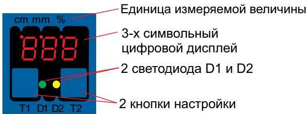
Рисунок 4 – Схема компоновки дисплея, светодиодов и кнопок датчика
