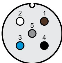
Рисунок 5 – Расположение контактов разъема со стороны датчика
