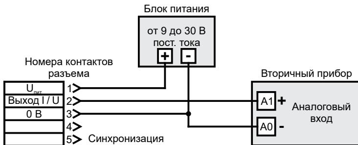
Рисунок 9 – Схема подключения *mic+.../IU/TC*
