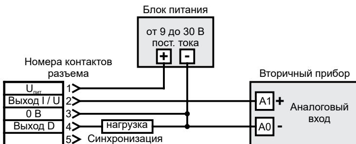
Рисунок 10 – Схема подключения *mic+.../DIU/TC*
