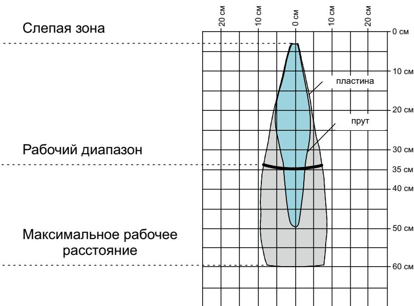
Рисунок 41 – Зона распространения ультразвуковой волны датчика *mic+35/...*
