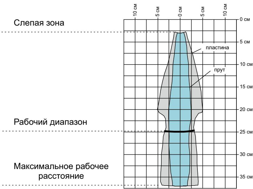
Рисунок 40 – Зона распространения ультразвуковой волны датчика *mic+25/...*
