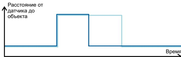
Рисунок 29 — Алгоритм работы датчика со стандартным фильтром
