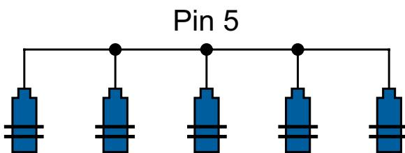
Рисунок 34 – Работа датчиков в режиме синхронизации
