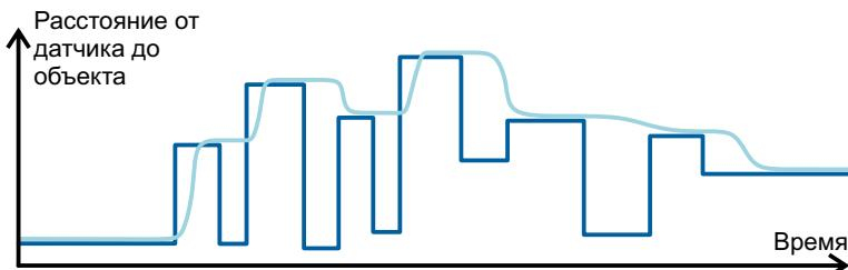
Рисунок 31 – Алгоритм работы датчика с фильтром переднего фронта
