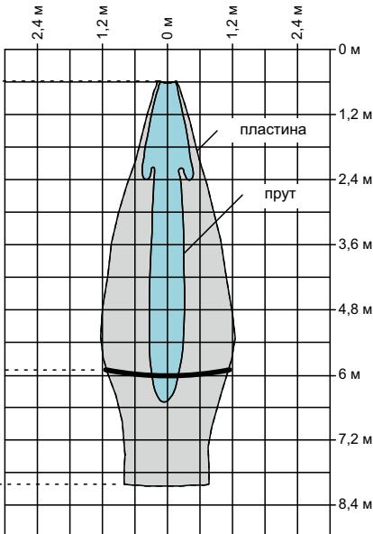
Рисунок 44 – Зона распространения ультразвуковой волны датчика *mic+600/...*
