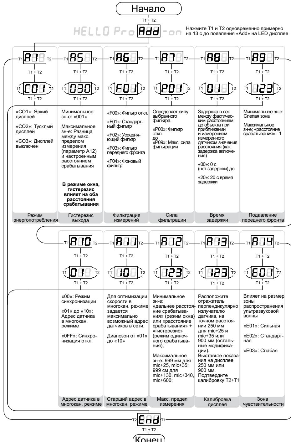
Рисунок 13 – Расширенные настройки параметров датчика mic+.../D/TC, mic+.../F/TC
