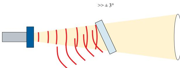
*Рисунок 37 – Отражение ультразвукового импульса под углом*
