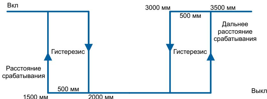
Рисунок 27 – Диаграмма работы дискретного выхода в режиме окна
