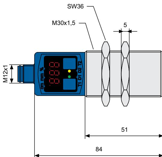
Рисунок 1 – Габаритные размеры *mic+25/..., mic+35/..., mic+130/...*
