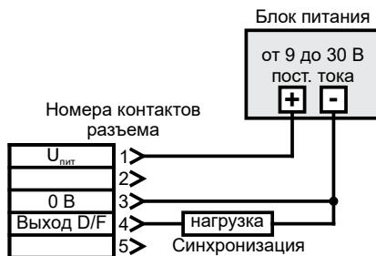
Рисунок 6 – Схема подключения mic+.../D/TC, mic+.../F/TC (подключение по схеме PNP)
