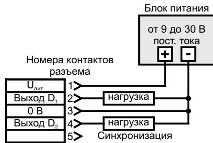
Рисунок 8 – Схема подключения *mic+.../DD/TC*
