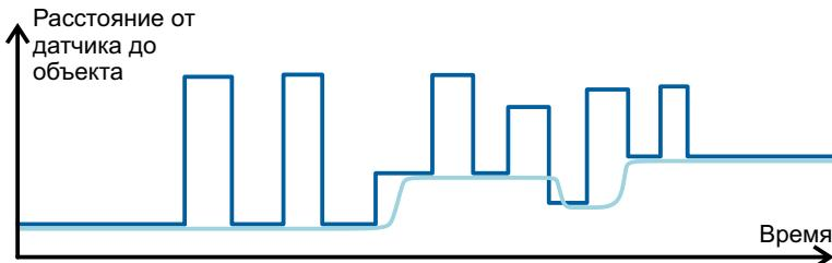
Рисунок 32 – Алгоритм работы датчика с фоновым фильтром
