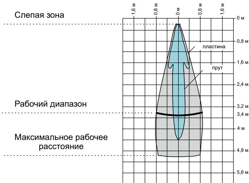
Рисунок 43 – Зона распространения ультразвуковой волны датчика *mic+340/...*
