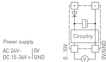
Si plusieurs appareils sont alimentés en 24V ca, il faut veiller à ce que toutes les entrées de tension « positives » (+) des appareils de terrain soient reliées entre elles de même que toutes les entrées de tension « négatives » (-) = potentiel de référence soient reliées entre elles (les appareils de terrain doivent être branchés en phase). Toutes les sorties d'appareil de terrain doivent se référer au même potentiel!
