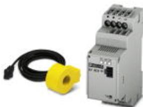
Das Differenz-Fehlerstrommodul dient zur AC- und DC-Fehlerstromerfassung in Wechselstrom-Ladepunkten. Die überlagerte Schutzeinrichtung (z. B. Fi-Schutzschalter) wird vor möglichen DC-Fehlerströmen geschützt. Es steht eine 1- oder 2-kanalige Produktvariante zur Verfügung.
