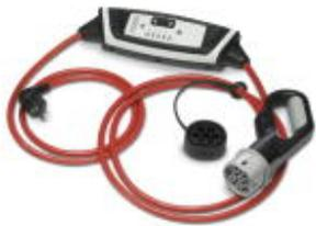
Mobile AC-Ladeleitung (Mode 2) mit Fahrzeug-Ladestecker und integrierter Steuereinheit (IC-CPD Lade-Controller), Typ 2, IEC 62196-2, Kabeldaten: 4 m, rot, gerade, Schutzkappe vorhanden
