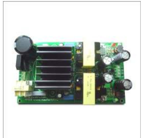
Рис.6 Вид на собранный блок питания с теплоотводом.
