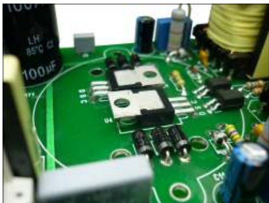
Рис.2 Установка TOP227 (U1, U4)
