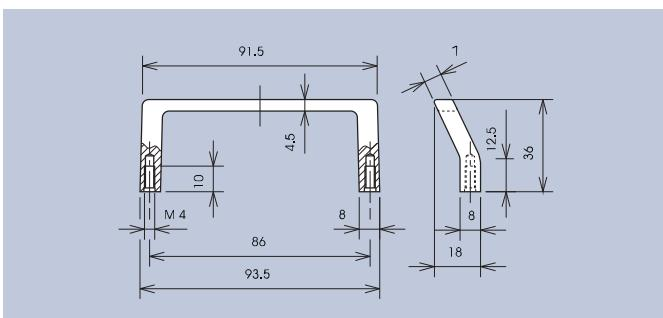
Einschließlich Zylinderschrauben-M4 x 10 und Scheiben.
