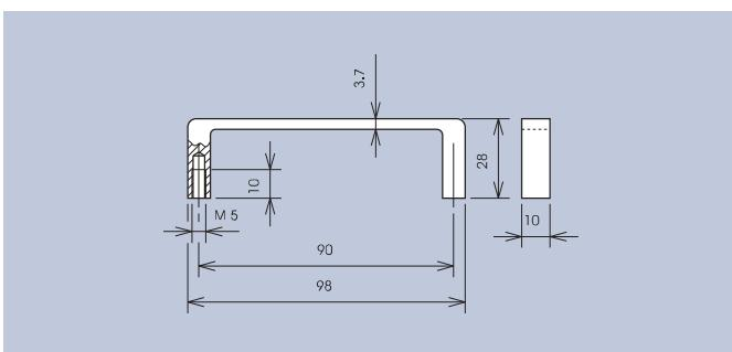
Einschließlich Zylinderschrauben-M5 x 12 und Scheiben.
