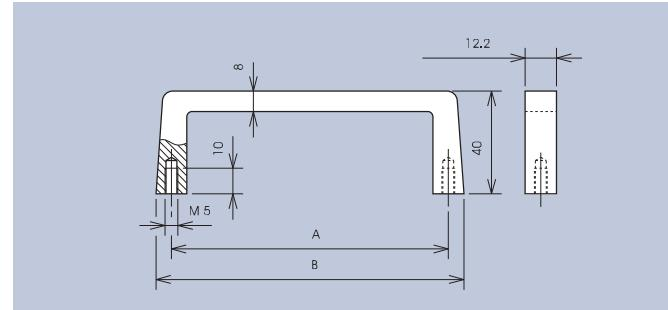
Einschließlich Zylinderschrauben-M5 x 12 und Scheiben.
