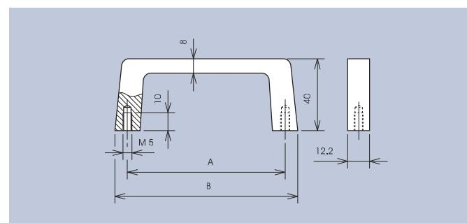
Einschließlich Zylinderschrauben-M5 x 12 und Scheiben.
