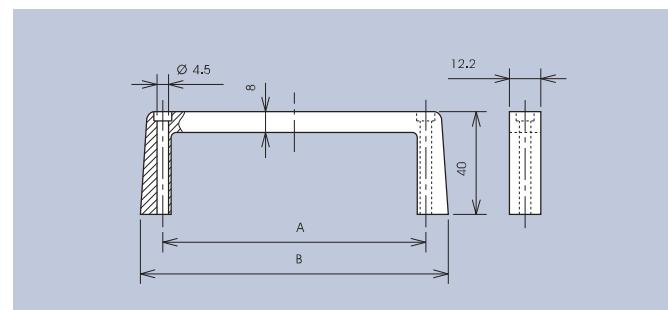
Einschließlich Zylinderschrauben-M4 x 45, Scheiben und Muttern.
