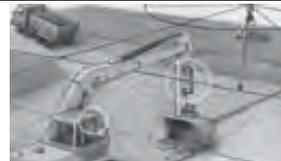
**Laser-Maschinenempfänger zur Baumaschinen-Steuerung**
