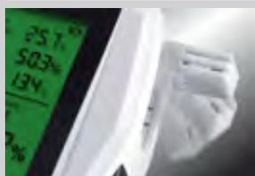
Ausklappbarer Sensor zur Messung der relativen Luftfeuchte, der Umgebungstemperatur und Berechnung der Taupunkttemperatur
