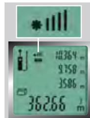
Das Balkendiagramm zeigt an, wie gut die Reflexionsfläche zur Messung geeignet ist. Das ist besonders hilfreich bei Messungen auf weite Entfernungen, dunklen Oberflächen oder bei hellem Umgebungslicht.
