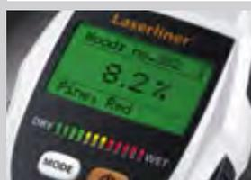
Hohe Genauigkeit durch wählbare Materialkennlinien
