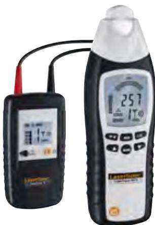
**Inklusive:** Sender CableTracer TX, Empfänger RECV, Anschlusskabel, Messspitzen, Messklammern, Batterien, Tragekoffer
