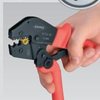
**Первый этап:** Двумя пальцами сдвинуть губки так, чтобы обе губки легли на опрессовываемый контакт
