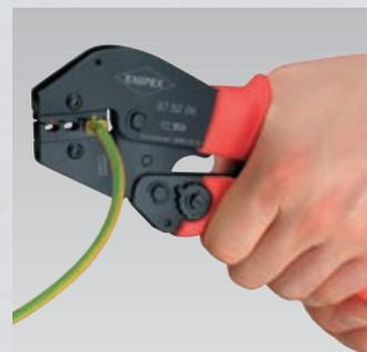
**Третий этап:** При необходимости увеличенного усилия опрессовки, например, для изолированных контактов 6,00 мм<sup>2</sup>; при наличии удлиненных ручек возможна работа обеими руками
