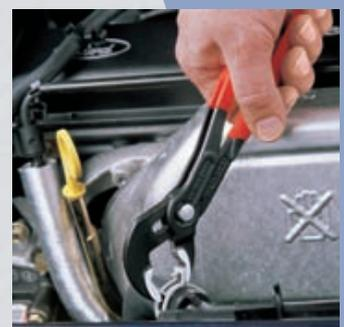
Фиксирующие плоскости со специально закаленными зубцами для надежного захвата различных деталей
