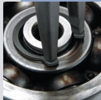
**Наконечники, выдерживающие высокие нагрузки:** наивысшая стойкость при демонтаже плотно сидящих колец
