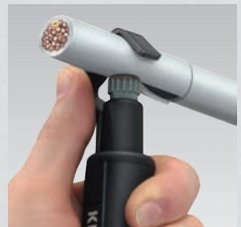
Точное удаление оболочки регулировкой глубины реза
