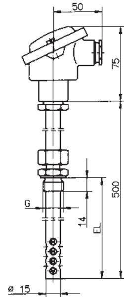
Betriebsdruck: Max. 16 bar bis 400 °C, ab 400 °C nur drucklos.
