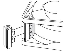
Distanzhalter aus glasfaserverstärktem Kunststoff. Zur Montage mit Schrauben über beide Lüftungs-Befestigungsflansche.
