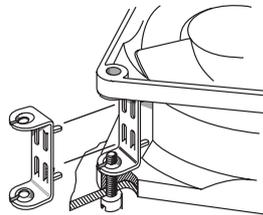
Bügfeder Mutter aus rostgeschütztem Federstahl. Zur Befestigung von Lüftern mit einer Gewindeschraube 3,5 DIN 797.
