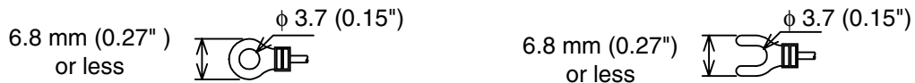
Figure 4.1: ENG ⌘ Crimp Terminals for M3.5 Screws FRE ⌘ Cosse de câble avec raccordement serti pour vis M3,5 GER ⌘ Kabelschuhe mit Quetschanschluss für M3,5-Schrauben ITL ⌘ Capocorda con collegamento a scatto per viti M3,5 ESP ⌘ Manguitos de cable con conexión de apriete para tornillos M3,5
