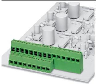
Printklemme, Nennstrom: 13,5 A, Bemessungsspannung: 250 V, Raster: 5,08 mm, Polzahl: 2, Montageart: Löten, Anschlussart: Schraubanschluss, Anschlussrichtung vom Leiter zur
