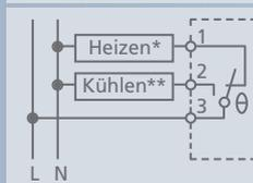
\* Im Kühlbetrieb Wechselkontakt.
