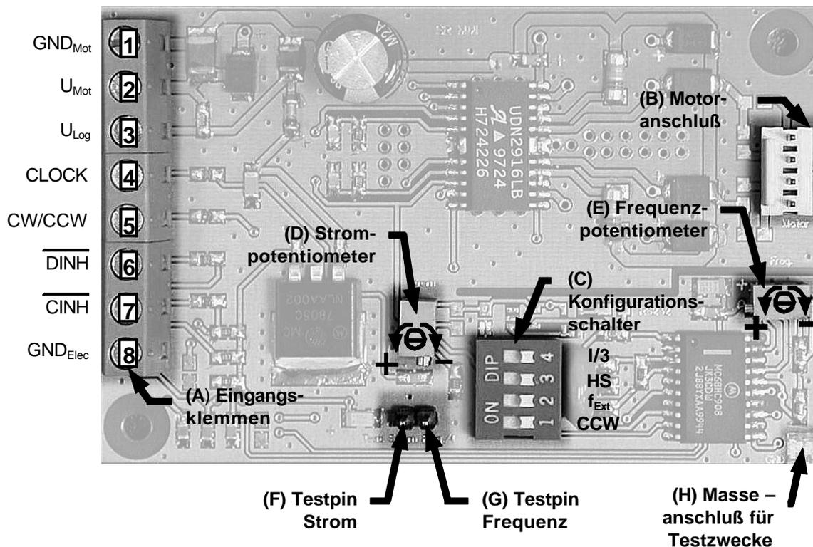
**Beachten Sie** die Eingangspegel (LS-TTL-Pegel). Um ein LOW zu generieren muß der Eingang mit GND verbunden werden. Wird der Eingang offen gelassen, so wird dies als HIGH erkannt. Eingangsspannungen  $>5\text{V}$  können die SAMOTRONIC102 zerstören.
