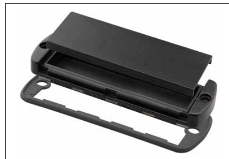
ABM...AL – монтажная крышка обладает углублённой монтажной поверхностью для встройки различных штекерных разъемов и втулок. Чтобы обеспечить класс защиты IP 65 для монтажного пространства, нащёлкивается алюминиевая крышка с уплотнением.
