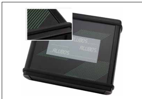
Профили корпусов с пазами для установки печатных или монтажных плат. С обеих сторон находятся углублённые поверхности для монтажа плёночных клавиатур. Боковые поверхности имеют эргономичное оформление.
