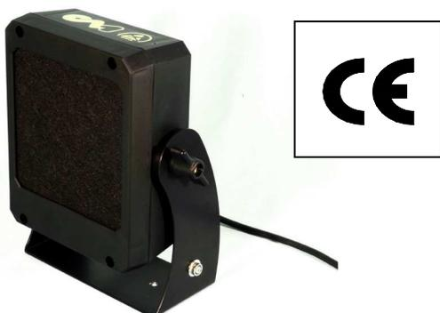
Il **CA1S** soddisfa le esigenze di tutela igienica del posto di lavoro. All'interno della cappa è inserito uno speciale filtro trattato con carboni attivi che, reagendo con i fumi di saldatura, trattiene le impurità create dai fluxanti, garantendo così l'eliminazione di fastidiosi gas.
