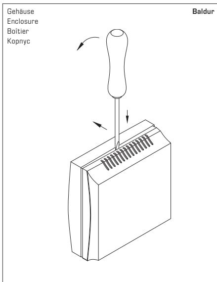
Zum Öffnen des Gehäuses einen Schraubendreher (2,0) in die Nut mittig ansetzen, nach unten drücken und den Bodenrahmen etwas anheben. Den Deckel nach vorne ziehen und halten.
