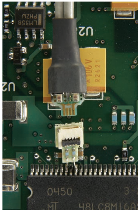
InfiniiMax ZIF tip soldered on board
