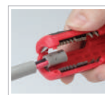
Stripping low volt cable
