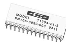
Низкопрофильный корпус с однорядным расположением выводов, расположенных под прямым углом.
