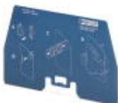
Trennplatte für NS-35/7,5 Tragschienen im isolierten Aufbau (Hutschiene ist über Auflagebock „AB/NS“ isoliert) zur Sicherstellung des Fadenmaßes von 50 mm zwischen Controller und Überspannungsschutz bei PT-IQ-EX-Systemen.
