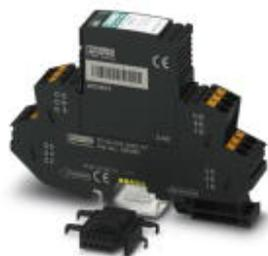
Überspannungsschutz, bestehend aus Schutzstecker und Basiselement, mit integrierter mehrstufiger Statusanzeige am Modul für vier Signaladern mit gemeinsamem Bezugspotenzial.
