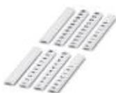
Zackband flach, Streifen, weiß, beschriftet, längs bedruckt: fortlaufende Zahlen 1-10, 11-20 usw. bis 491-500, Montageart: Verrasten in flacher Schildchennut, für Klemmenbreite: 5 mm, Schriftfeldgröße: 5,15 x 5,15 mm
