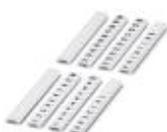
Zackband flach, Streifen, weiß, beschriftet, längs bedruckt: fortlaufende Zahlen 1-10, 11-20 usw. bis 491-500, Montageart: Verrasten in flacher Schildchennut, für Klemmenbreite: 5 mm, Schriftfeldgröße: 5,15 x 5,15 mm
