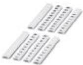
Zackband flach, Streifen, weiß, beschriftet, quer bedruckt: fortlaufende Zahlen 1-10, 11-20 usw. bis 91-100, Montageart: Verrasten in flacher Schildchennut, für Klemmenbreite: 5 mm, Schriftfeldgröße: 5,15 x 5,15 mm
