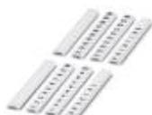
Zackband flach, Streifen, weiß, beschriftet, längs bedruckt: fortlaufende Zahlen 2-20, 22-40, usw. bis 82-100, Montageart: Verrasten in flacher Schildchennut, für Klemmenbreite: 5 mm, Schriftfeldgröße: 5,15 x 5,15 mm
