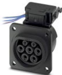
Infrastruktur-Ladedose zum Laden mit Wechselstrom (AC) von Elektrofahrzeugen, kompatibel zu Infrastruktur-Ladesteckern, Typ 2, IEC 62196-2, 32 A / 480 V (AC), 12 V Verriegelungsaktuator, Einzeladern, Länge: 1,5 m, Verschraubung eines Klappdeckels: Nur rückseitig möglich
