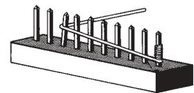
**Falsche** Leiterverlegung. Der Draht ist gespannt.
