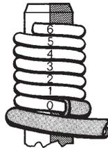
Der **Modifizierte Wickel-einsatz** wickelt zusätzlich zum blanken Leiter etwa eine Windung mit der Isolierung um den Wickelstift. (Die Isolierung der Verbindung der Verdrahtungsebene 2 darf die letzte Leiter-
